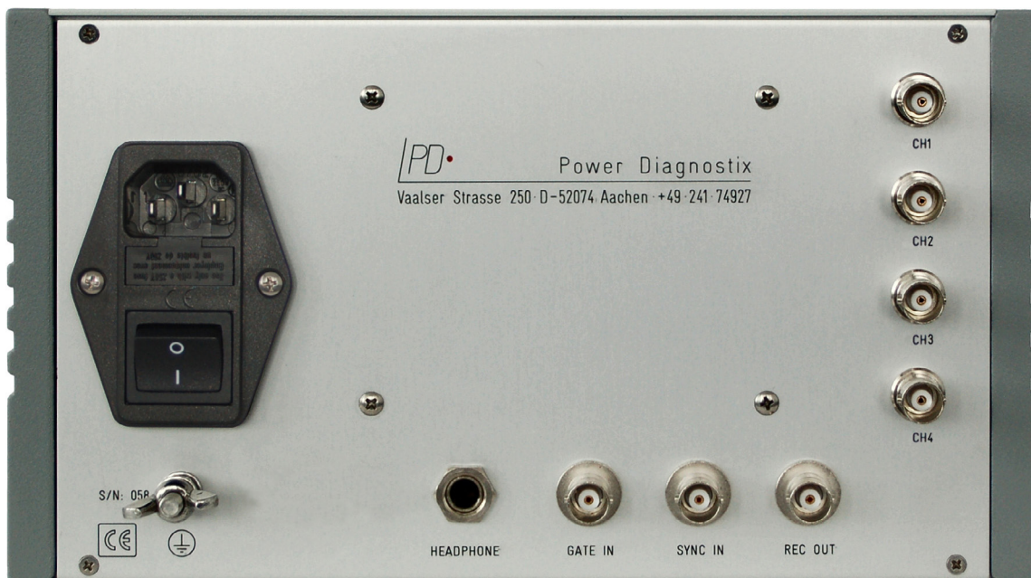
Abb. 3.2: Rückwand eines AIAcompact-Modells mit 1/2-19-Zoll-Größe
