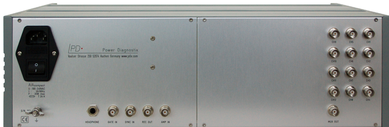
Abb. 3.4: Rückwand eines AIcompact im 19-Zoll-Gehäuse mit Zwölf-Kanal-Multiplexer
