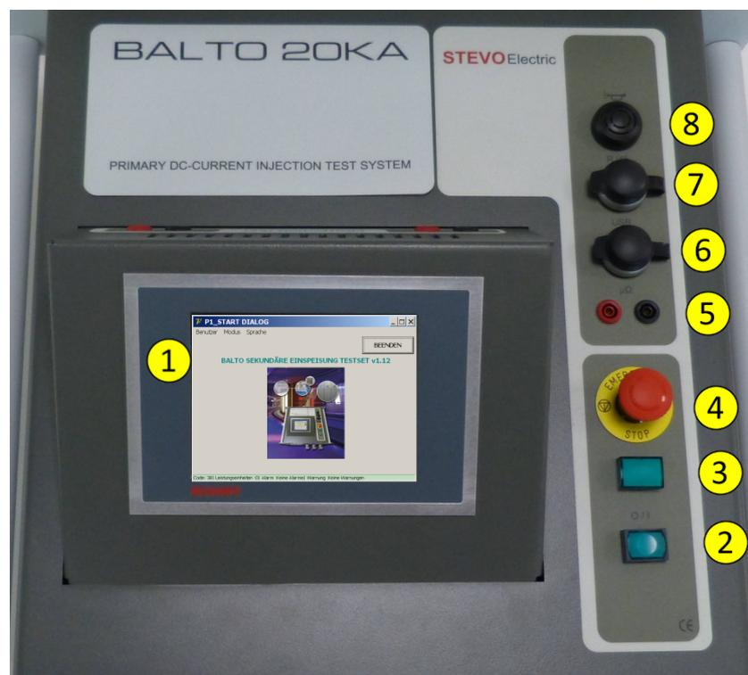
Abb. 2: Kontrolleinheit: Bedienerfeld.
