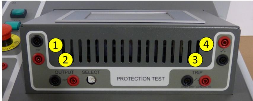
Abb. 6: Kontrolleinheit: Anschluss DC Schutzrelais.
