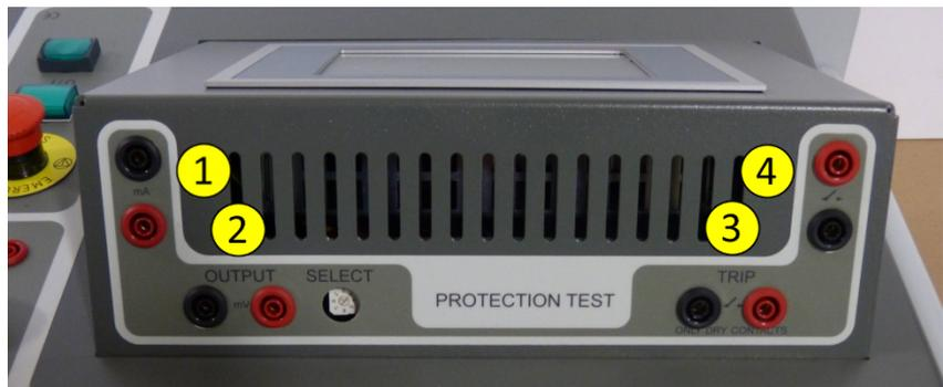
Abb. 9: Kontrolleinheit: Anschlüsse BALTO Controller - DC Schutzrelais.
