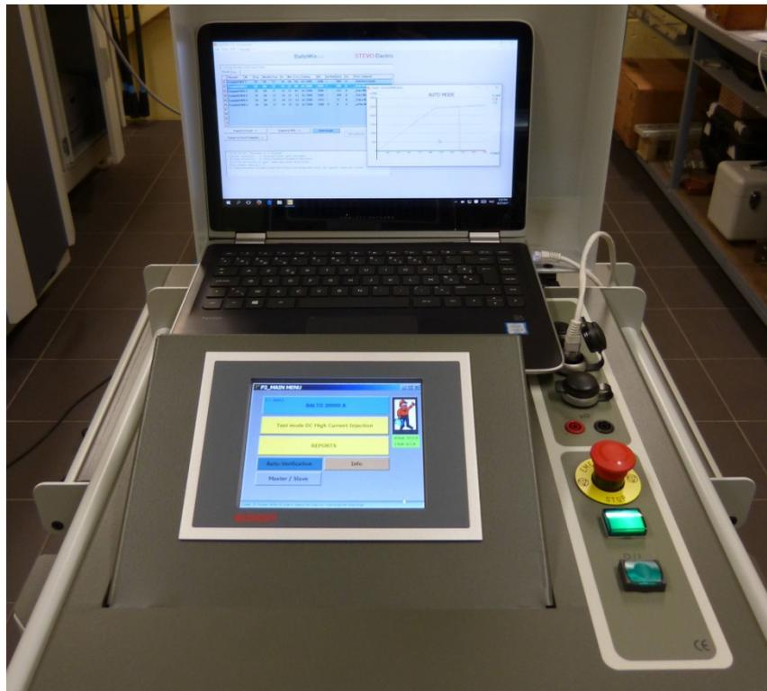
Abb. 15: Kontrolleinheit: Laptop mit Anwendung BaltoWin.
