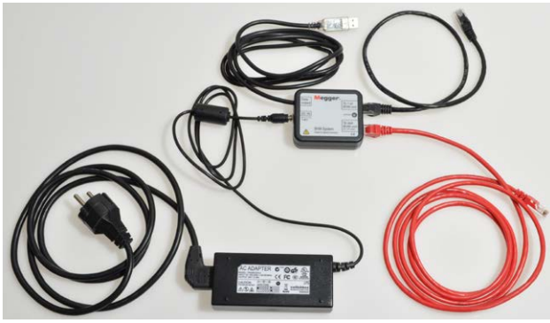
Die anderen Teile des BVM-Systems: AC-Adapter, Versorgungs- und Signalanschluss sowie Kabel
