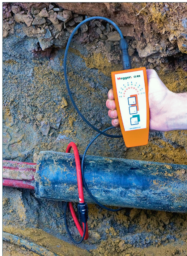
Captación de señal: aplicación del receptor CI RX y de la pinza flexible AZF
