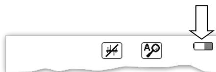
Sollte der Balken kaum noch gefüllt sein, empfiehlt es sich, Ersatzbatterien mitzuführen. Ab Restkapazität von etwa 20% leuchten sowohl die Batteriestatusanzeige als auch die LED der Taste rot.
