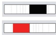
Der Mantelfehler befindet sich in Richtung des mit der schwarzen Messleitung verbundenen Erdspießes
