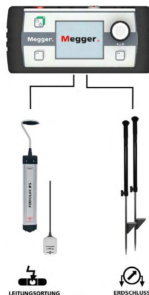
Nach Anschluss zweier Erdspeie wechselt die Kontrolleinheit zur Schrittspannungsmethode. Ein Signalgenerator erzeugt an der Fehlerstelle einen Spannungstrichter.
