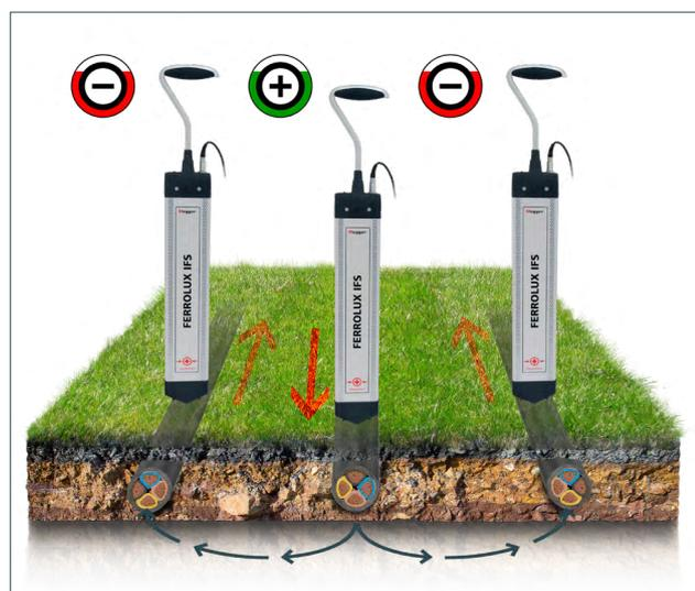
Liegen mehrere Leitungen (Kabel, Rohre) nebeneinander, stellt sich die Frage welches das Richtige ist. Manchmal kann das Signal vom Generator durch beide fließen, aber das wird in unterschiedlichen Richtungen der Fall sein. Dafür gibt es die Funktion SignalSelect. Der Generator speist ein Signal ein, das eine Richtungsinformation hat. Wenn man über dem richtigen Kabel steht, erscheint ein „+“ zur genauen Identifizierung.
