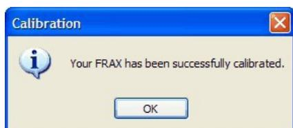
Alle Kalibrierdaten werden im FRAX-Gerät gespeichert. Es kann kein schriftlicher Bericht über die Software aufgerufen werden, so dass ein separater Kalibrierungsbericht vorgeschlagen wird, der manuell erstellt werden muss.
