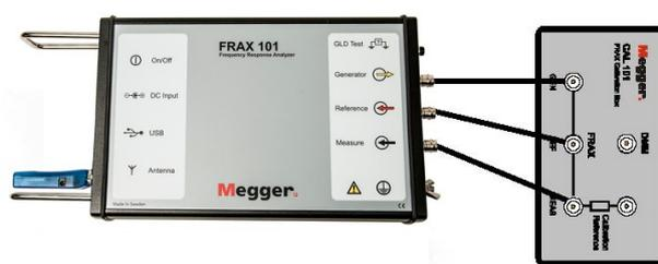
Von 10 Hz bis 10 MHz messen, wobei die Messdaten 0 dB mit einer maximalen Abweichung von  $\pm 0,1$  dB betragen sollten.
