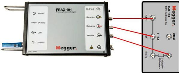
Bei der Standardansicht sollte die Magnitudenkurve zwischen 10 Hz und 100 kHz bei etwa -80 dB liegen.
