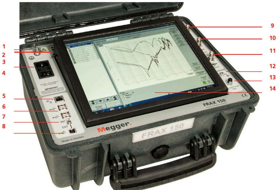
1. **Masseanschluss (Schutzleiter)** Das Gerät immer über das separate Erdungs-/Massekabel an die Schutz Erde/Masse der Station anschließen. Der separate Erdungs-/Masseleiter sollte die zuerst hergestellte und die zuletzt entfernte Verbindung sind.
