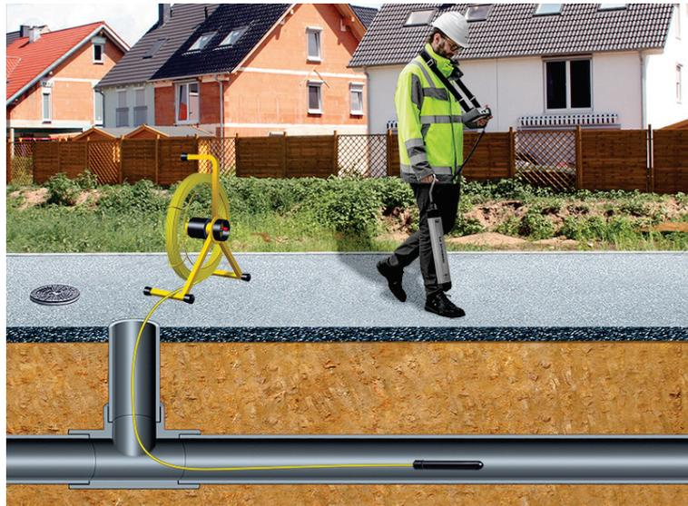
Si el receptor se encuentra directamente sobre la sonda y está orientado en línea con respecto a él, se mide entonces el máximo de señal.
