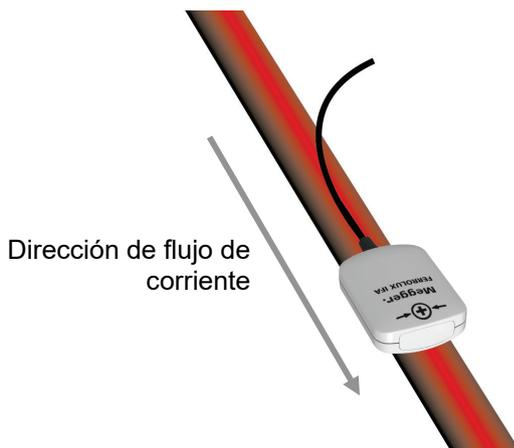
**Métodos de lectura** Para poder leer con fiabilidad el cable objetivo de entre un cúmulo de ellos colocados unos junto a otros debería emitirse una señal codificada con SignalSelect por éste.
