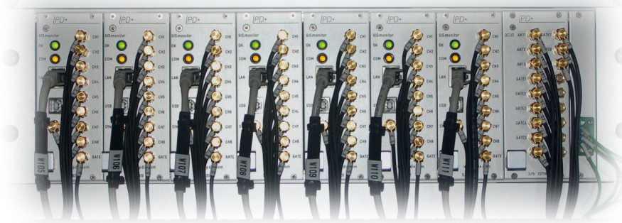
Abbildung 12: GISmonitor eingebaut in einem 19-Zoll-Baugruppenträger
