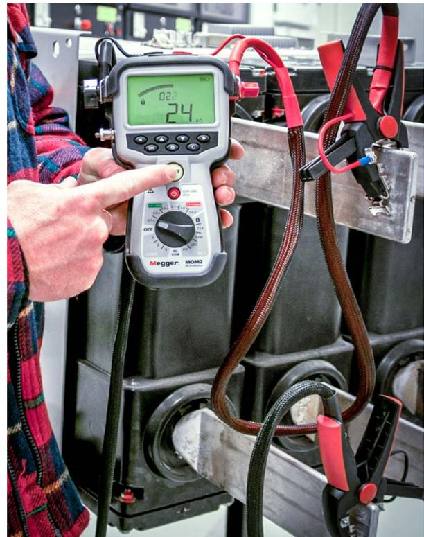
Halten Sie die Messzangen / befestigen Sie die Kelvin-Klemmen am Leistungsschalter und drücken Sie zum Triggern / Knopf TEST. Ein Signal zeigt an, ob die Prüfung GUT oder SCHLECHT war und das Ergebnis wird auf dem Gerät zum späteren Herunterladen auf den PC gespeichert.
