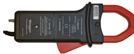
Hall-Effekt-Stromzange 600 A Gleichstrom und 400 A Wechselstrom (CP-600DC-ID)
