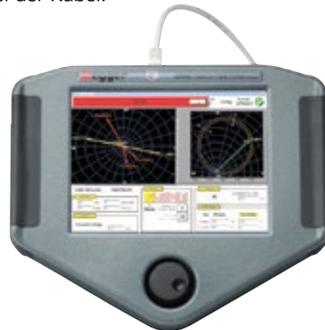
Der große Farbbildschirm ermöglicht, dass der Anwender alle relevanten Daten während der Prüfungsdurchführung ablesen und die Stromwandler-Sättigungskurve betrachten kann. Das Gerät kann zudem so konfiguriert werden, dass es ohne eine Megger STVI geliefert wird; dann wird es über einen Laptop mit Hilfe der PowerDB-Software von Megger gesteuert.
