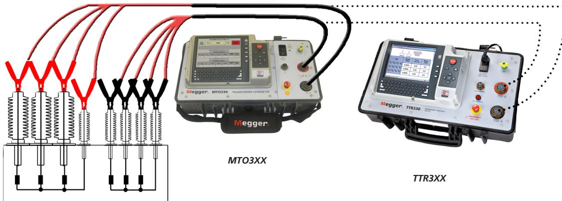
El diagrama muestra los instrumentos serie MTO3xx y TTR300 que utilizan de manera sencilla y cómoda, el mismo juego de cables de prueba. Por ejemplo, el usuario puede dejar los conductores conectados al transformador y utilizar el mismo juego de cables para la medición de la relación de espiras con los instrumentos serie TTR3xx, eliminando así varios movimientos de subida y bajada por la escalera de mano.
