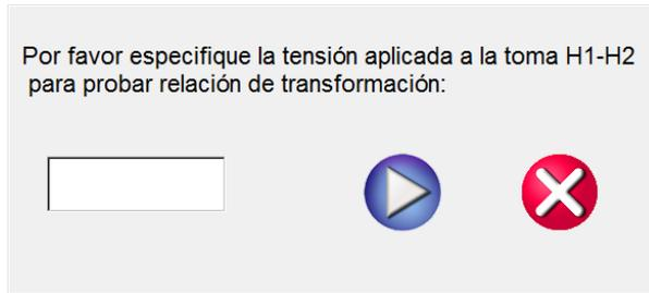
17 Introduzca un voltaje entre 1 V y 300 V que sea inferior a la tensión de codo del TC.
