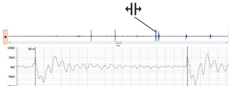
Im oberen Teil der Anzeige wird die Übersicht über die aufgezeichneten Messdaten abgebildet. Darin werden alle als ortbare TE-Ereignisse identifizierten Impulse mit schwarzen Linien gekennzeichnet. Mit Hilfe der Schaltflächen und kann zwischen diesen Positionen hin- und hergeschaltet werden. Im eigentlichen Diagramm wird jeweils
