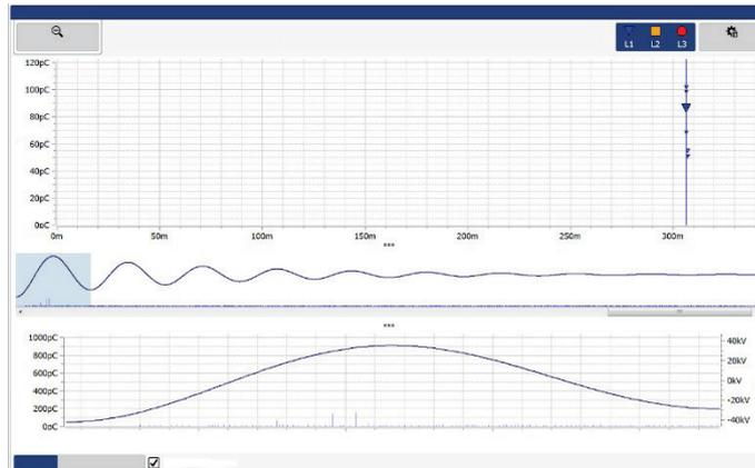
Im oberen Bereich des Bildschirms wird standardmäßig das TE-Mapping mit den bisher aufgezeichneten TE-Ereignissen angezeigt. Der direkt darunter angezeigte Diagrammtyp kann im Verlauf der Messung über die Reiter an der Unterseite beliebig umgeschaltet werden.
