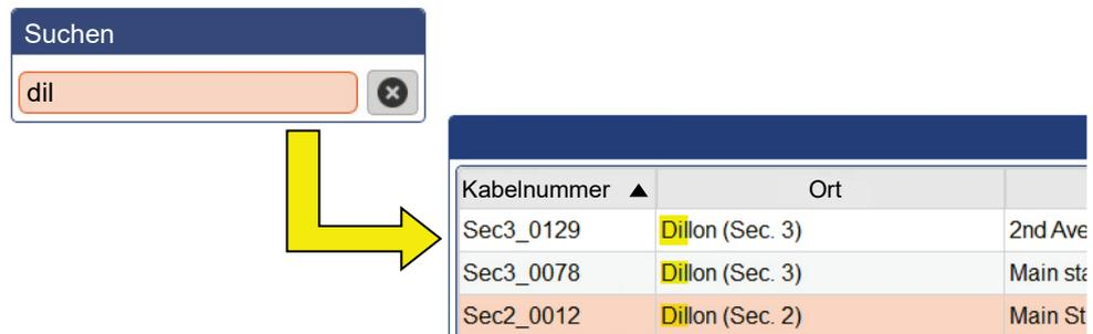
Um die Filterung aufzuheben, muss entweder die Zeichenkette gelöscht oder, wenn vorhanden, die Schaltfläche angeklickt werden.
