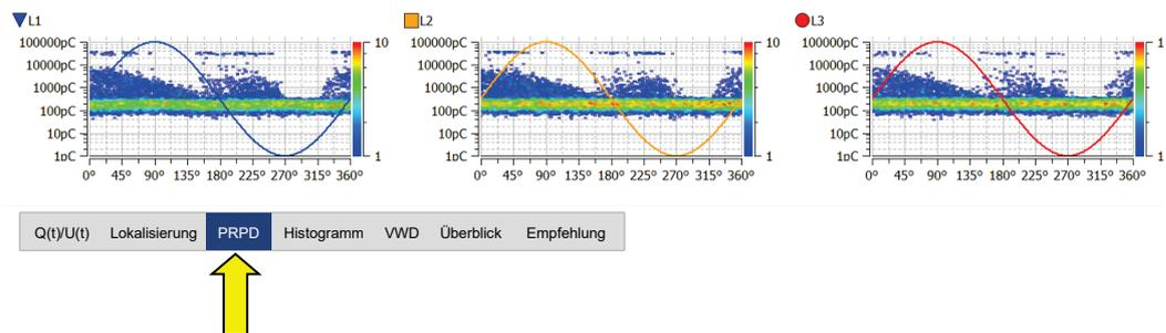
Aus diesen Diagrammen, welche die Verteilung der Ladungsimpulse relativ zur Phasenlage zeigen, lassen sich häufig fundierte Aussagen zur Charakteristik / Ursache einer TE-Fehlstelle ableiten. Die Aussagekraft der Darstellung hängt allerdings stark von der Menge der aufgezeichneten Messdaten ab.
