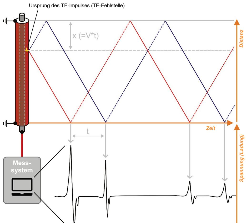
Aus der Zeitdifferenz eines solchen Impulspaars und der bekannten oder bei der vorangegangenen Kalibration ermittelten Impulsausbreitungsgeschwindigkeit kann dann die Position der TE-Fehlstelle berechnet werden.
