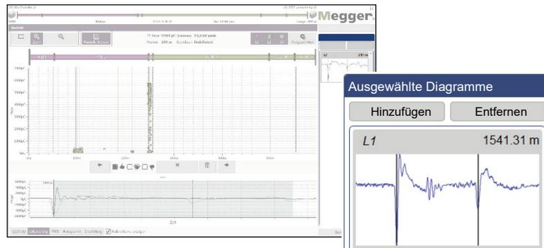
Die in der Auswahl enthaltenen Impulse können durch einen einfachen Klick selektiert und zur Anzeige gebracht werden. Durch einen weiteren Klick auf die Schaltfläche **Entfernen** können sie auch wieder aus der Auswahl gelöscht werden.
