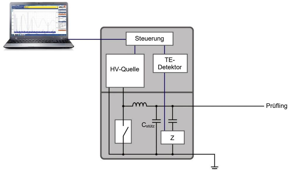
Die Steuerung der Spannungsquelle sowie die Anzeige und Auswertung der Messdaten erfolgt über ein mittels Netzwerkschnittstelle verbundenes Notebook. Mit Hilfe der vorinstallierten Software lassen sich sämtliche für die Messung und Lokalisierung von Teilentladung notwendigen Bedienhandlungen durchführen. Die Auswertung und Verwaltung der Messdaten kann dabei je nach Belieben entweder direkt nach der Messung oder später im Büro durchgeführt werden.
