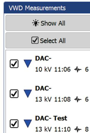
Über die Schaltfläche **Alle anzeigen** können auch alle anderen verfügbaren VWD-Diagramme eingeblendet und betrachtet werden. Um eines der bisher nicht berücksichtigten VWD-Diagramme mit in den Bericht aufzunehmen, ist die entsprechende Checkbox zu aktivieren.
