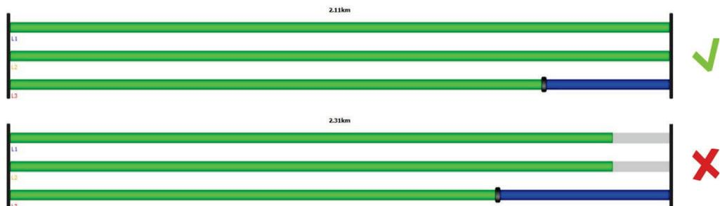
*Abschnitt hinzufügen / bearbeiten* Mit Hilfe von drei über der Liste angeordneten Schaltflächen können nach folgendem Schema Kabelabschnitte hinzugefügt und bearbeitet werden:
