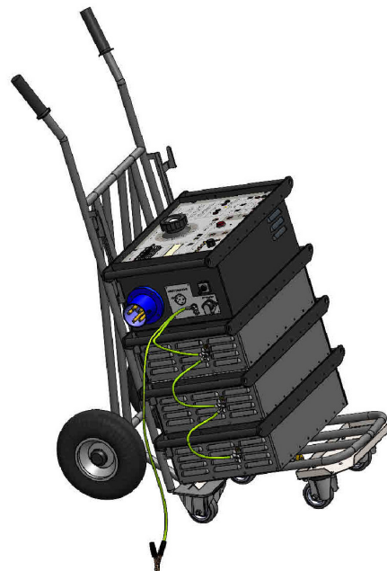
Cable de red de conexión a tierra
