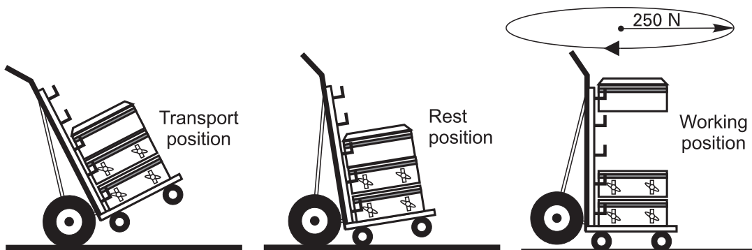
Fig 6.1 Diferentes posiciones para el ODEN AT carro de transporte. Tenga en cuenta, en posición de trabajo, el carro de transporte debe estar garantizado para evitar que vuelque. Seguro que a un objeto apropiado por ejemplo, un polo o una mesa.
