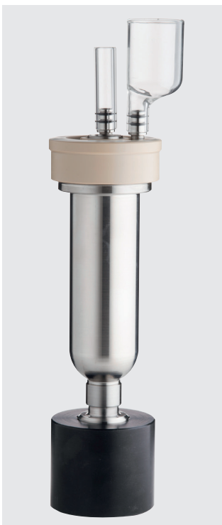
Komplett montierte Prüfkammer im Montageständer mit Glasbehälter und Steigrohren.
