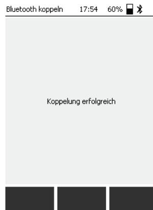
Nach erfolgreicher Erstkopplung muss der Kopfhörer zukünftig nur noch nach dem PD Scan eingeschaltet werden und sollte sich dann automatisch mit diesem verbinden. Das
