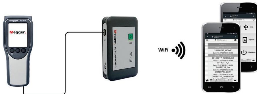
Direkt nach Anschluss eines PD Scan an das WMSD erfolgt außerdem ein automatischer Download aller neuen Messdatensätze in den internen Speicher des WMSD. Dank dieser Funktion kann das Massenspeichergerät auch dazu genutzt werden, die Messdaten von mehreren im Einsatz befindlichen Messgeräten einzusammeln, ohne diese dazu erst ins Büro bringen zu müssen.
