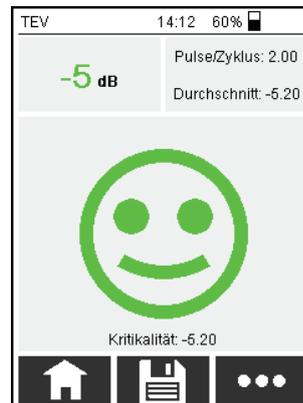
Der angezeigte Durchschnittswert errechnet sich aus den Pegel-Messwerten der zurückliegenden 10 Sekunden.
