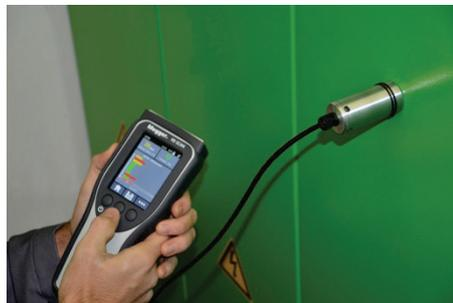
Die richtige Anwendung spielt bei diesem Sensortyp eine entscheidende Rolle. Der Sensorkopf muss bündig auf einer möglichst glatten Oberfläche aufgesetzt werden. Selbst bei kleinsten Lufteinlässen besteht die Gefahr, dass durch Teilentladungen verursachte Signale nicht gemessen werden können.
