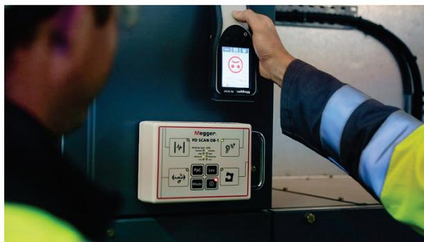
Die Box nimmt direkt nach dem Einschalten den Betrieb auf und generiert teilentladungsähnliche Impulse. Pegel und Häufigkeit der Impulse, sowie die Art der Auskopplung richten sich dabei nach den aktuellen Einstellungen, die mit Hilfe der Tasten auf der Frontplatte wie folgt angepasst werden können:
