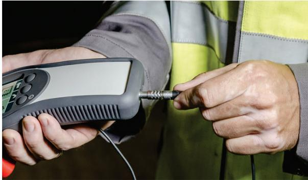
Das Gerät erkennt den angeschlossenen Sensor nach dem Einschalten selbst und bietet dementsprechend die möglichen Betriebsarten an.
