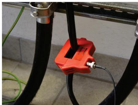
Prinzipiell kann der PD Scan auch in Kombination mit anderen HFCT-Kopplern genutzt werden, sofern diese über eine zugängliche BNC-Schnittstelle verfügen. Es kann jedoch je nach verwendetem Sensor zu Abweichungen in der Pegelanzeige kommen. Der PD
