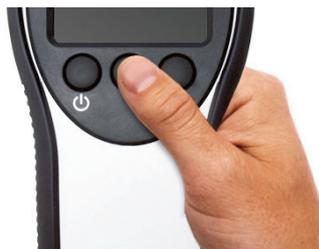
5. Lassen Sie auch die mittlere Taste wieder los. Im Display sollte nach wenigen Sekunden die Meldung **Bootloader** erscheinen.
