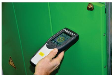
*Flexibler Luftschall-Sensor* Dieser externe akustische Sensor ist speziell für Schlitze, Luftlöcher, Ritzen konzipiert, aus denen die Schallwellen der Teilentladungen aus der Schaltzelle entweichen könnten.
