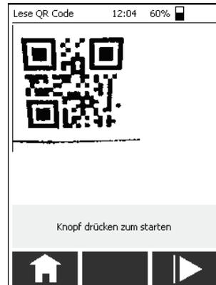
3. Halten Sie den PD Scan an den QR-Code und betätigen Sie die Schaltfläche
