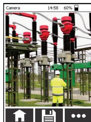
Wenn das zu- und abschaltbare grüne Kreuz (siehe Seite 50) in der Mitte des Bildschirms angezeigt wird, sollte dieses bei der Bildaufnahme möglichst genau auf die identifizierte Problemstelle oder eine sonstige für die Messung relevante Position gerichtet werden. Die grüne Markierung ist später auch in der Bilddatei sichtbar.
