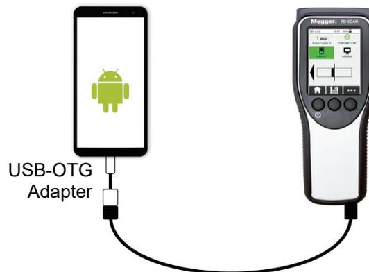
Anschließend können die im internen Speicher des PD Scan abgelegten Messdaten mit Hilfe einer geeigneten Android-Dateiverwaltungs-App bequem und schnell per E-Mail-, Messaging- oder Cloud-Dienst verteilt werden.
