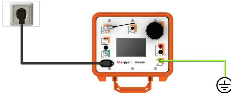
Diese Versorgungsspannung dient im Normalfall gleichzeitig auch als Referenzspannung. Sollte sie sich aus irgendeinem Grund nicht dafür eignen, kann die Referenzspannung aber auch über den Eingang  $U_x$  ⑨ abgegriffen werden. Die Spannungsversorgung per Netzzuleitung muss aber auch in diesem Fall gewährleistet werden!
