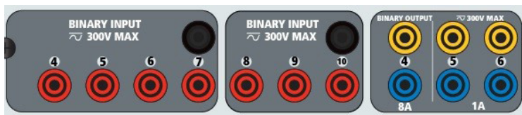
Abbildung 365. Binäreingänge 4 bis 10 und Binärausgänge 4 bis 6
