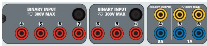
Abbildung 396. Binäreingänge 4 bis 10 und Binärausgänge 4 bis 6
