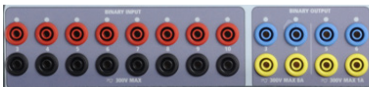
Abbildung 327. Option-„P“-Binäreingänge 3 bis 10 und Binärausgänge 3 bis 6
