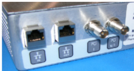
Abbildung 295. Rack-Montage des SMRT1 - Signal- und Kommunikationsanschlüsse an der Rückplatte
