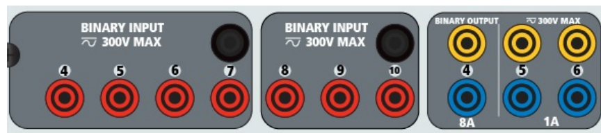
Figura 289 Entradas binarias 4 a 10 y salidas binarias 4 a 6
