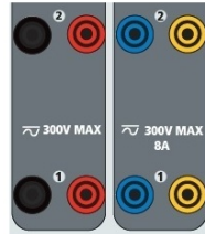
Figura 288 Entradas y salidas binarias 1 y 2
