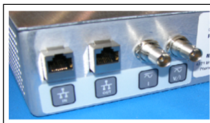
Figura 243 Puertos de señal y comunicación del panel posterior del montaje en bastidor SMRT1
