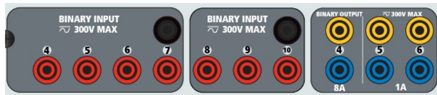
Figura 320 Entradas binarias 4 a 10 y salidas binarias 4 a 6
