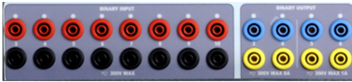
Figura 305 Opción "P" Entradas binarias 3 a 10 y salidas binarias 3 a 6
