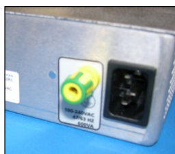
Figura 242 Entrada de alimentación del panel posterior del montaje en bastidor SMRT1
