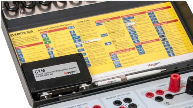
Mit dem Stromwandler-Magnetisierungs-Instrument wird die Kniepunktspannung eines Stromwandlers bestimmt.
