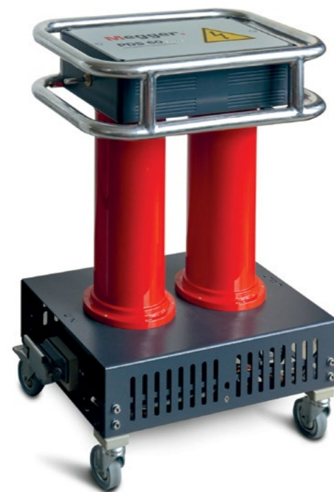
PDS 60: Teilentladungsmodul geeignet für VLF Sinus, 50 Hz Slope und gedämpfte Wechsellspannung
