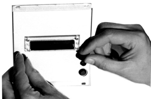
Bild 42: Frontplatte Einbaudrucker lösen
