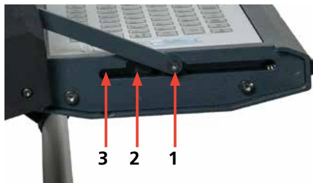
Die Tastatur hat drei feste Positionen außer der geschlossenen Position. Dieses Bild zeigt die Tastatur mit der Schiene in Position "1", welches die erste Position nach dem Öffnen ist.
