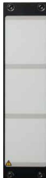
Ein Dummy-Modul wird immer in einen Steckplatz eingesteckt, in dem kein anderes Modul steckt. Dies ist für die Kühlung des TM1800 wichtig.
