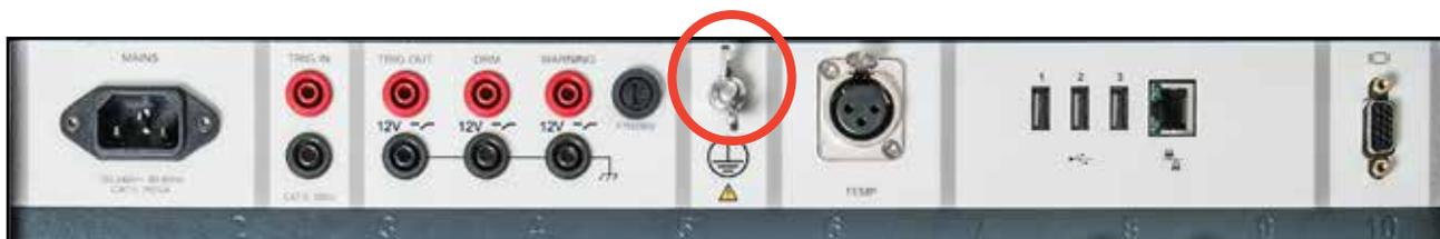
Abbildung 1.2-1. Schutzleiteranschlussklemme
