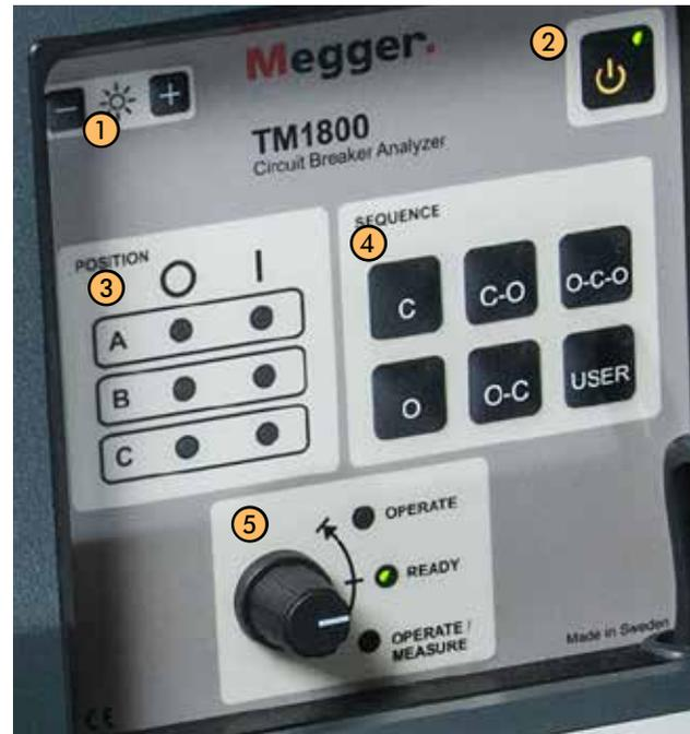
Über die Bedienfläche betreiben und überwachen Sie die Leistungsschalterposition, stellen die Vorgangsfolge ein und lassen die Messungen ablaufen.
