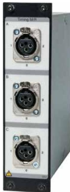
Das M/R Zeitmess-Modul misst die Zeit der Haupt- und Widerstands- (parallel) Kontakte. Das Modul misst bis zu sechs Schaltstrecken mit sowohl Haupt- als auch Widerstandskontakt, was insgesamt 12 Messkanäle ergibt. Das TM1800-System kann mit mehreren M/R Zeitmess-Modulen ausgestattet sein, die jede Art der durchzuführenden Prüfeinstellung ermöglicht. Alle drei Anschlüsse (Phasen) sind galvanisch isoliert und haben eine eingebaute Spannungsquelle.
