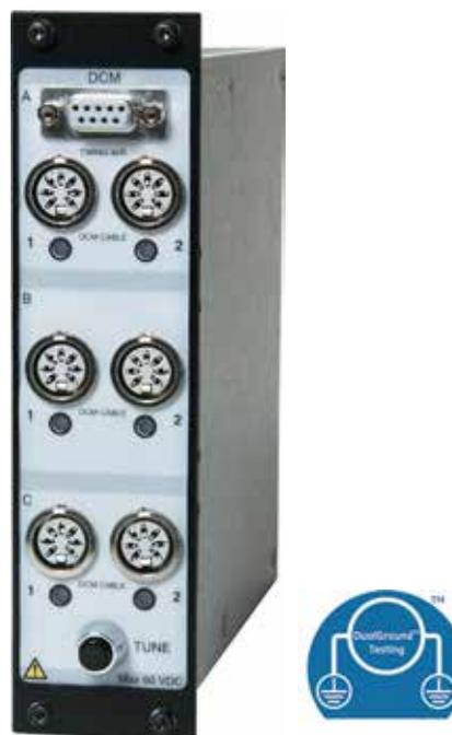
Das DCM-Modul verwendet eine Messtechnologie, die als Dynamische Kapazitätsmessung bezeichnet wird. Ein Modulpaar DCM und Zeitmessung M/R misst die Zeit an bis zu 6 Schaltvorgängen (z.B. dreiphasige Leistungsschalter mit zwei Schaltern pro Phase), wobei beide Seiten geerdet sind, DualGround™ Technologie. Das TM1800-System kann mit mehreren DCM- und Zeitmess-M/R-Modulpaaren ausgestattet sein, die die Zeitmessung an bis zu 18 Schaltvorgängen ermöglichen.
