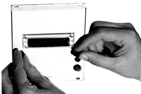
Bild 38: Frontplatte Einbaudrucker lösen
