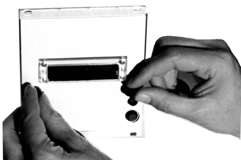
Bild 40: Frontplatte Einbaudrucker lösen
