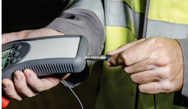
El equipo reconoce el sensor conectado después del encendido y, por consiguiente, ofrece los posibles modos de operación.
