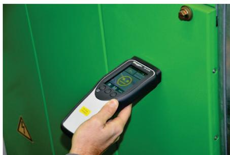
**Sensor de sonido aéreo flexible** Este sensor acústico externo se ha concebido en especial para aberturas, orificios de ventilación o grietas por donde podrían salir las ondas acústicas de las descargas parciales de la celda de conmutación.
