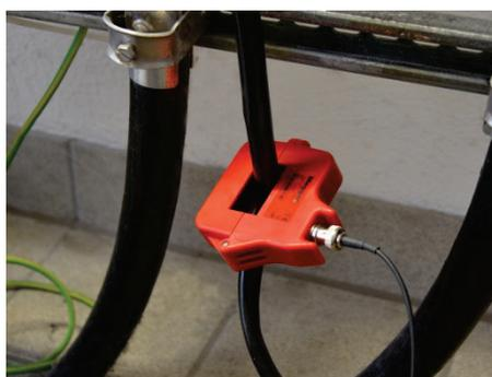
El PD Scan puede utilizarse principalmente también en combinación con otros acopladores HFCT, siempre que estos dispongan de un interfaz BNC accesible. En cualquier caso, dependiendo del sensor utilizado, pueden darse diferencias en las indicaciones de nivel. El PD Scan se ajusta a la perfección al sensor HFCT suministrado gracias su exactitud en la medición.
