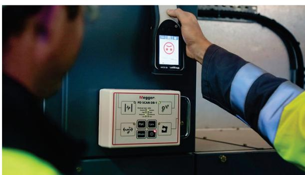
La Box inicia la operación inmediatamente después del encendido y genera pulsos similares a las descargas parciales. El nivel y la cadencia de los impulsos, así como el tipo de acoplamiento se atienen a los ajustes actuales, que con ayuda de las teclas de la placa frontal se pueden adaptar como se indica a continuación:
