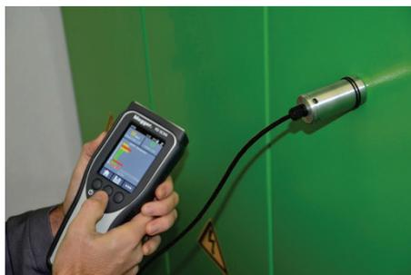
La aplicación adecuada juega un papel esencial en este tipo de sensor. El botón del sensor debe encajarse en una superficie lo más lisa posible. Incluso con las entradas de aire más diminutas existe el peligro de que, debido a las descargas parciales, no se puedan medir las señales generadas.
