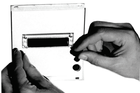
Bild 38: Frontplatte Einbaudrucker lösen
