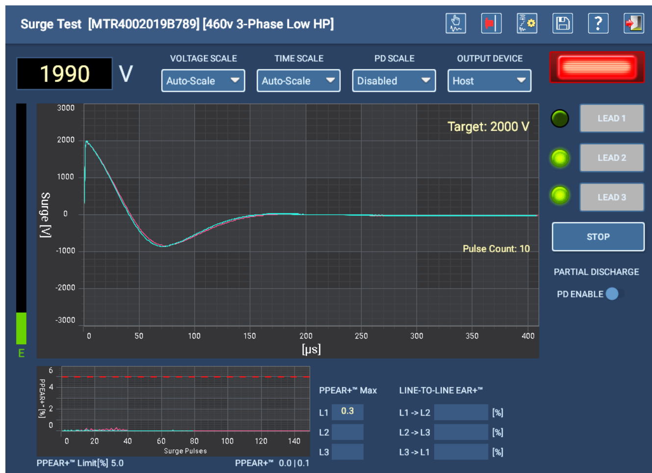
Fig. 125: Pantalla de prueba Auto Surge (Sobretensión automática).
