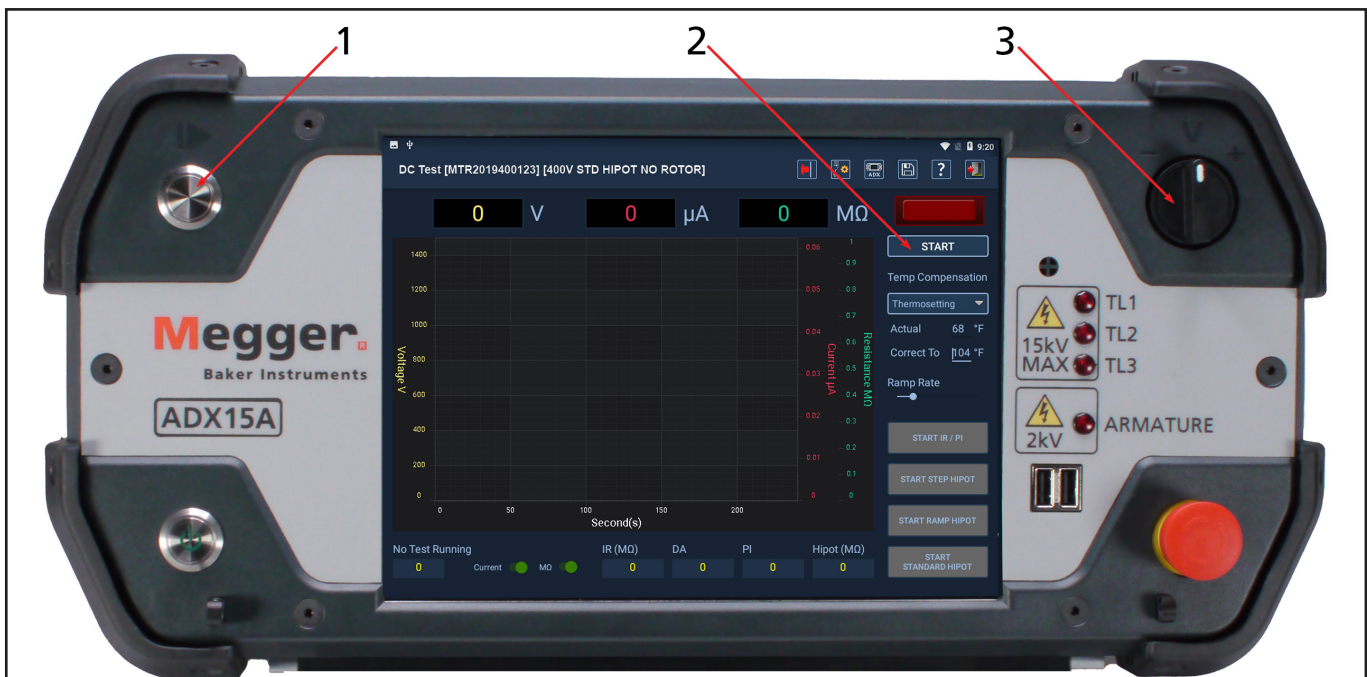
Fig. 85: Panel frontal ADX y controles de interfaz de usuario para iniciar la prueba de CC.
