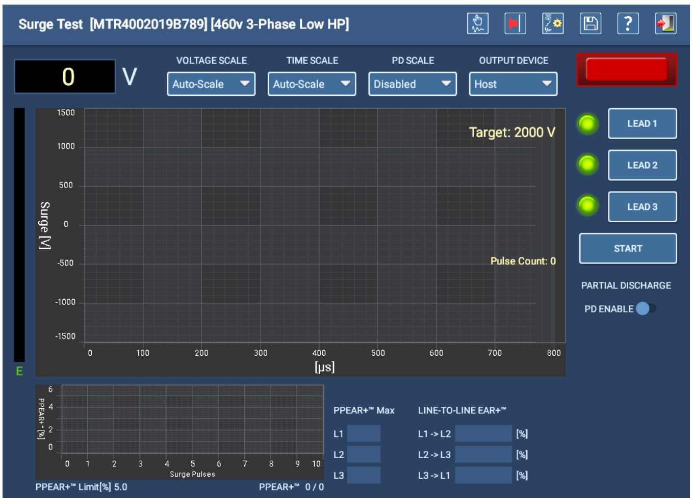
Fig. 110: Pantalla de prueba Auto Surge (Sobretensión automática): inicio.
