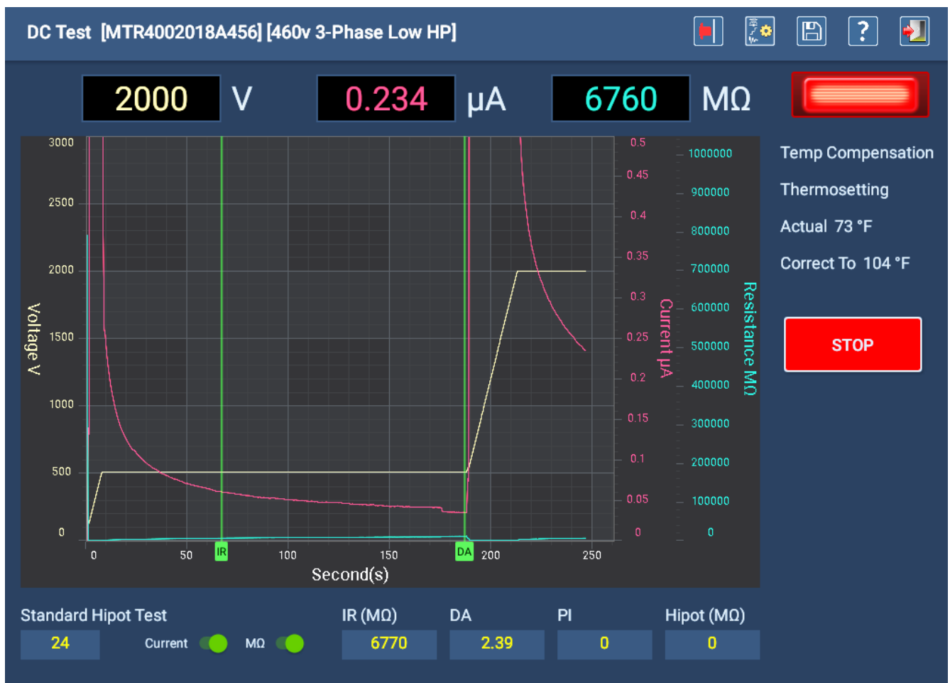
Fig. 124: Pantalla Auto DC Test (Prueba de CC automática): prueba en curso.
