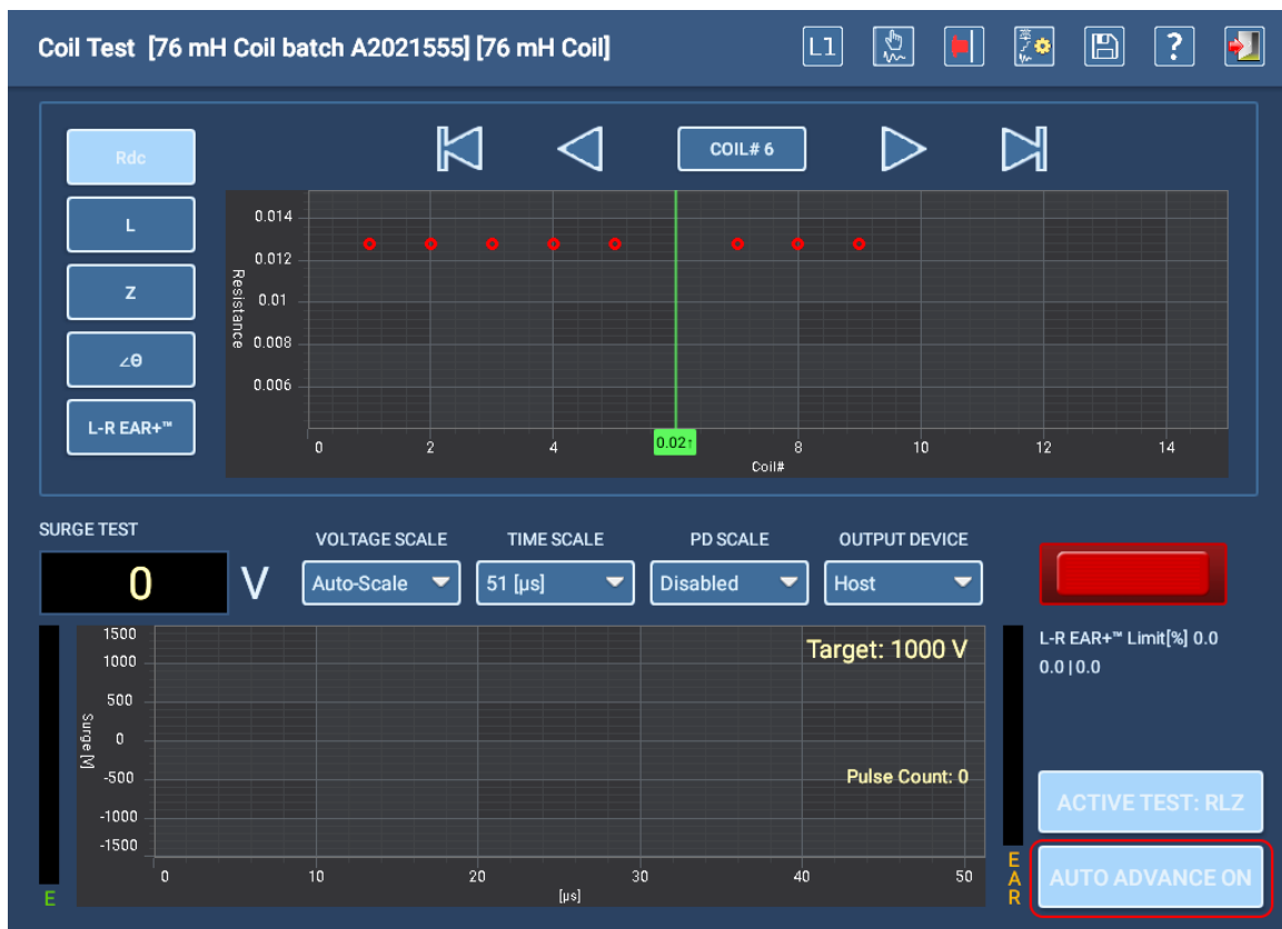
Fig. 100: Pantalla Coil Test (Prueba de bobina) con el ejemplo de prueba de RLZ en curso.
