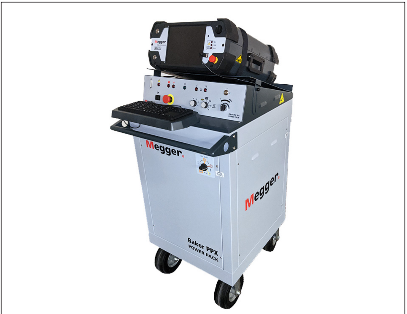
Fig. 9: Megger Baker ADX junto con Megger Baker PPX.
