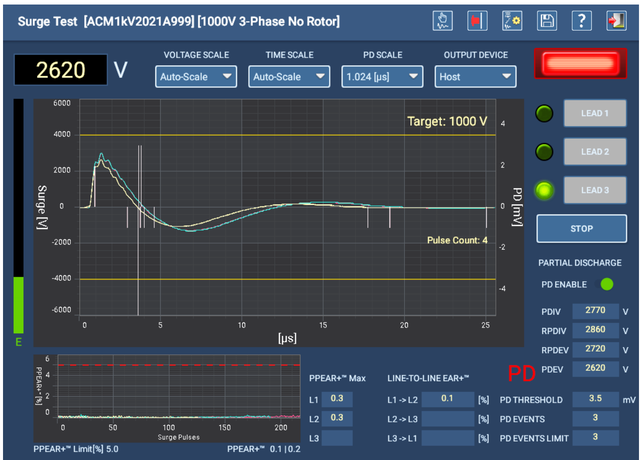
Fig. 118: Pruebas de sobretensión con PD en modo Automatic (Automático) para confirmar los ajustes.
