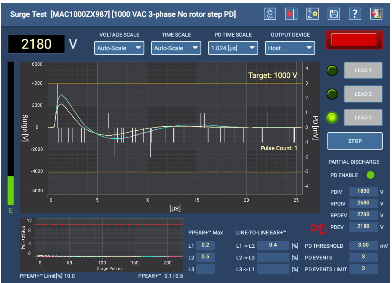
Fig. 114: Disminución de tensión hasta alcanzar a la tensión objetivo (1000 V aquí), con lo cual se capturan los valores de extinción para el cable 3.
