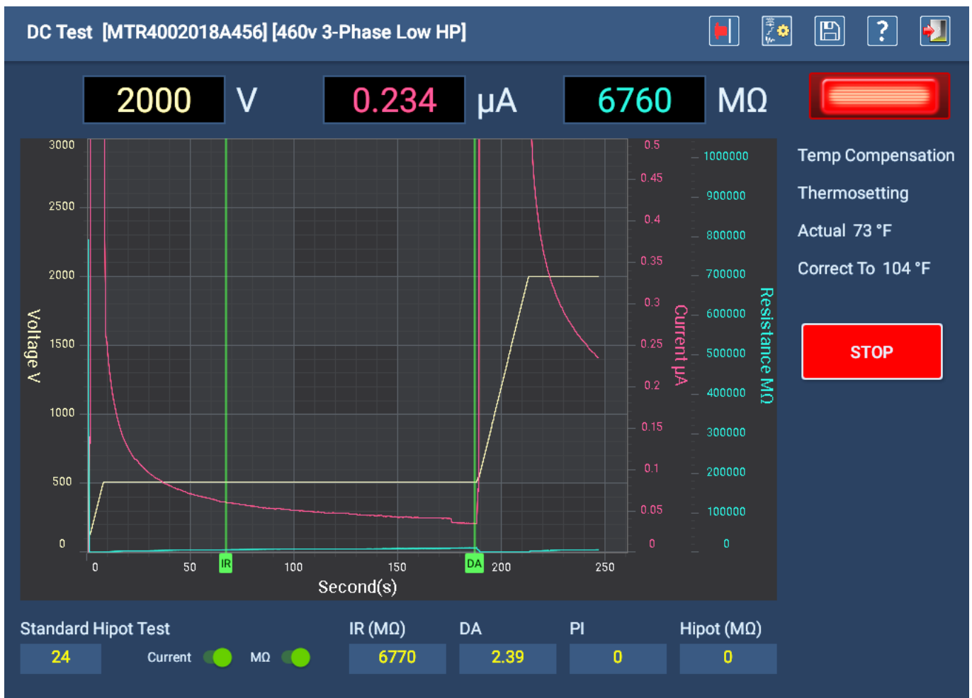
Fig. 108: Pantalla Auto DC Test (Prueba automática de CC) que ejecuta la prueba de alto potencial estándar.
