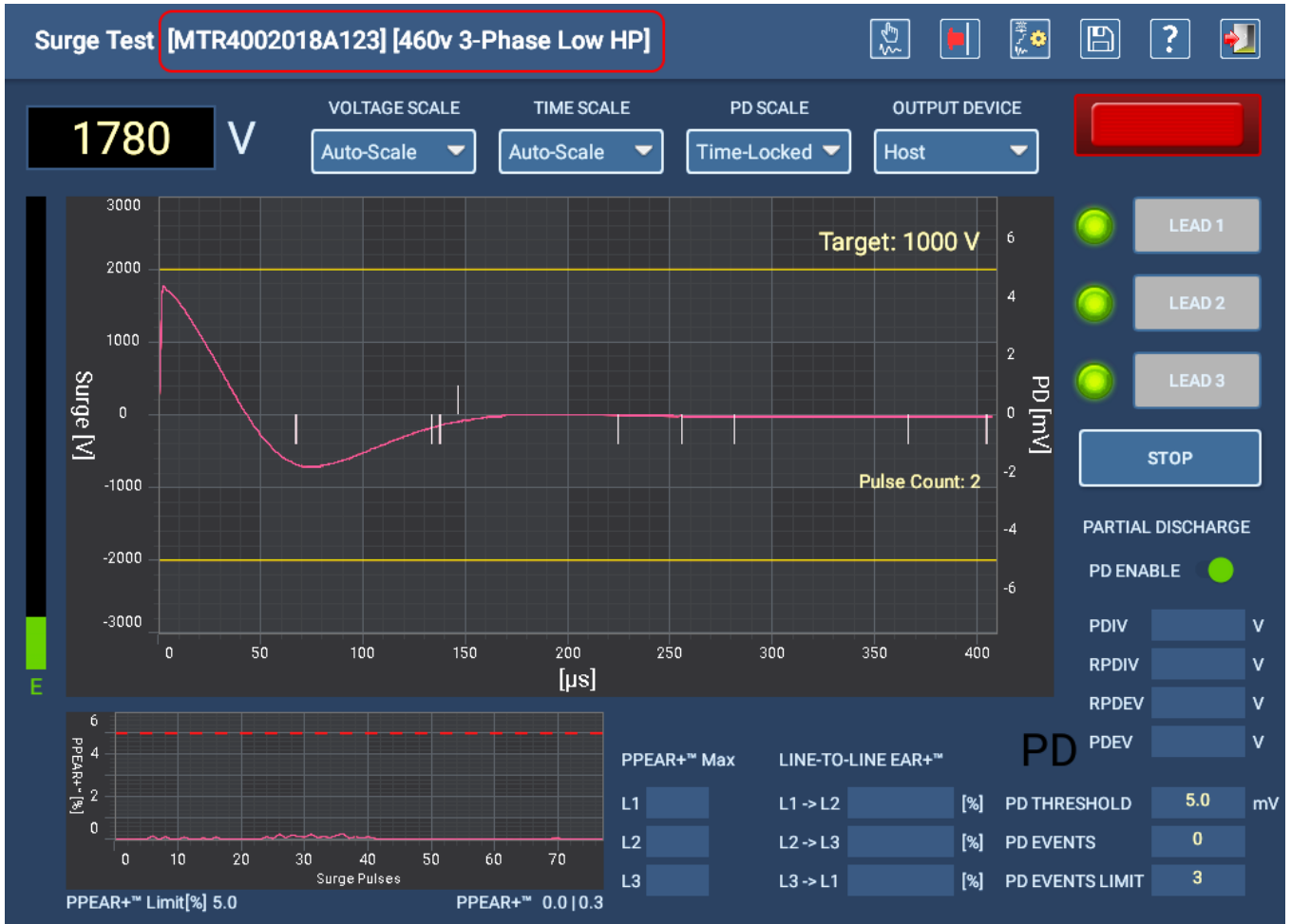
Fig. 77: Ejemplo de pantalla de prueba que muestra la selección de activo y configuración de prueba.
