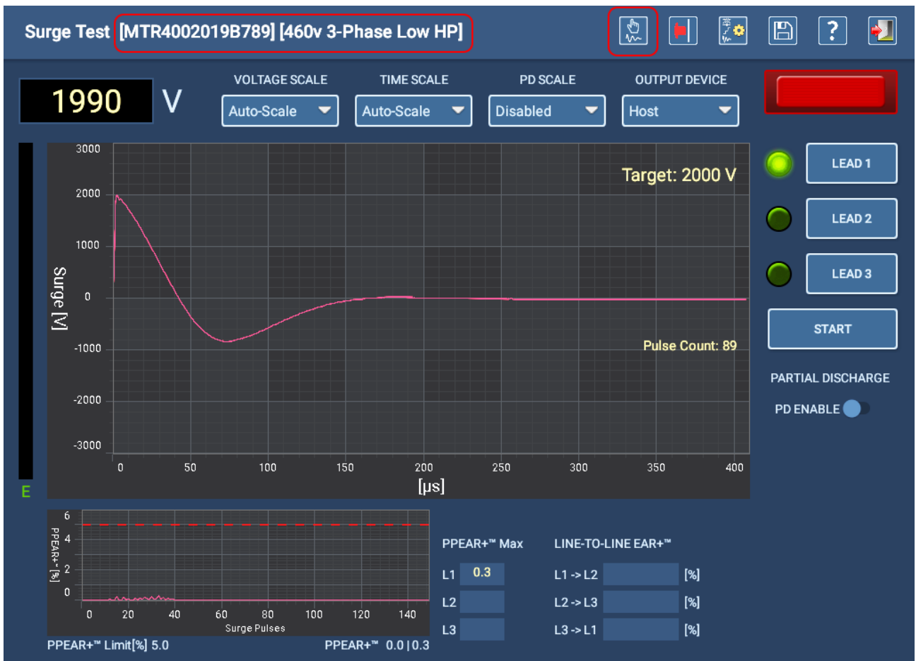
Fig. 89: Adquisición de la forma de onda de referencia para la Prueba de sobretensión en LEAD 1 (Cable 1).
