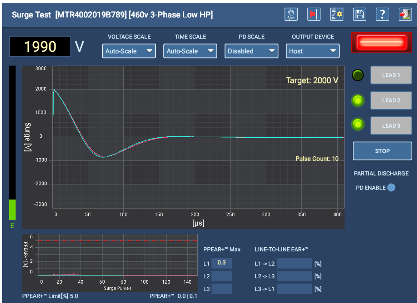
Fig. 111: Pantalla de prueba Auto Surge (Sobretensión automática): prueba en curso.
