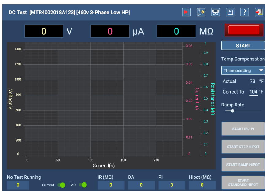
Fig. 83: Pantalla de inicio de prueba manual de CC.
