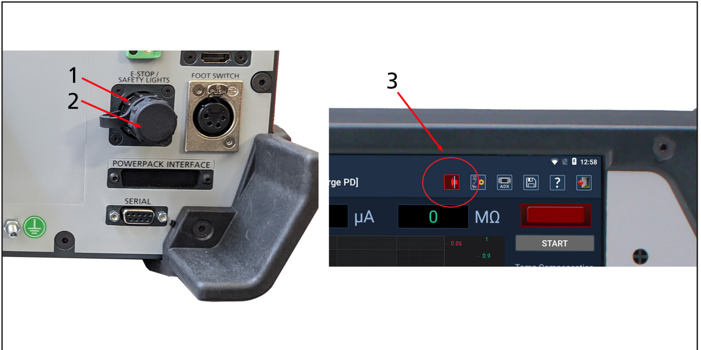
Fig. 7: Conector y tapa para puente de parada de equipos (izquierda). Indicador de parada del equipo en la barra de herramientas de la pantalla de prueba ADX (derecha).
