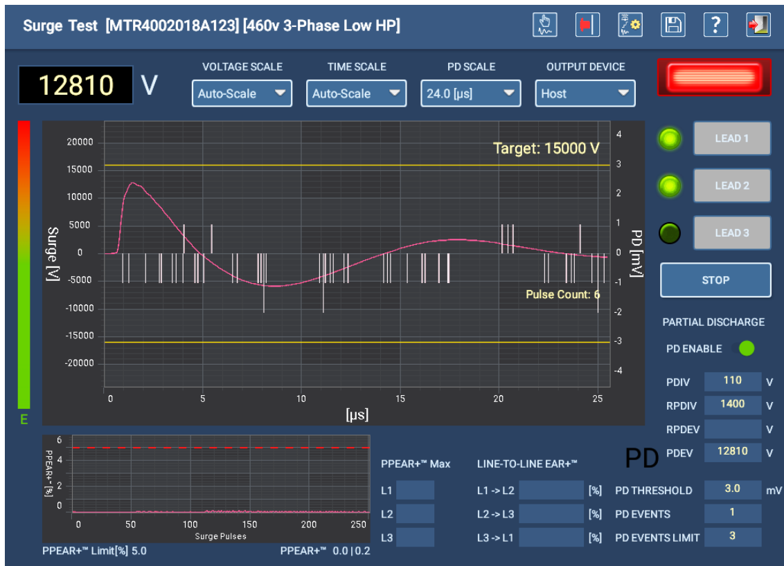
Fig. 119: Barra de energía de sobretensión que indica que se ha alcanzado la energía máxima.
