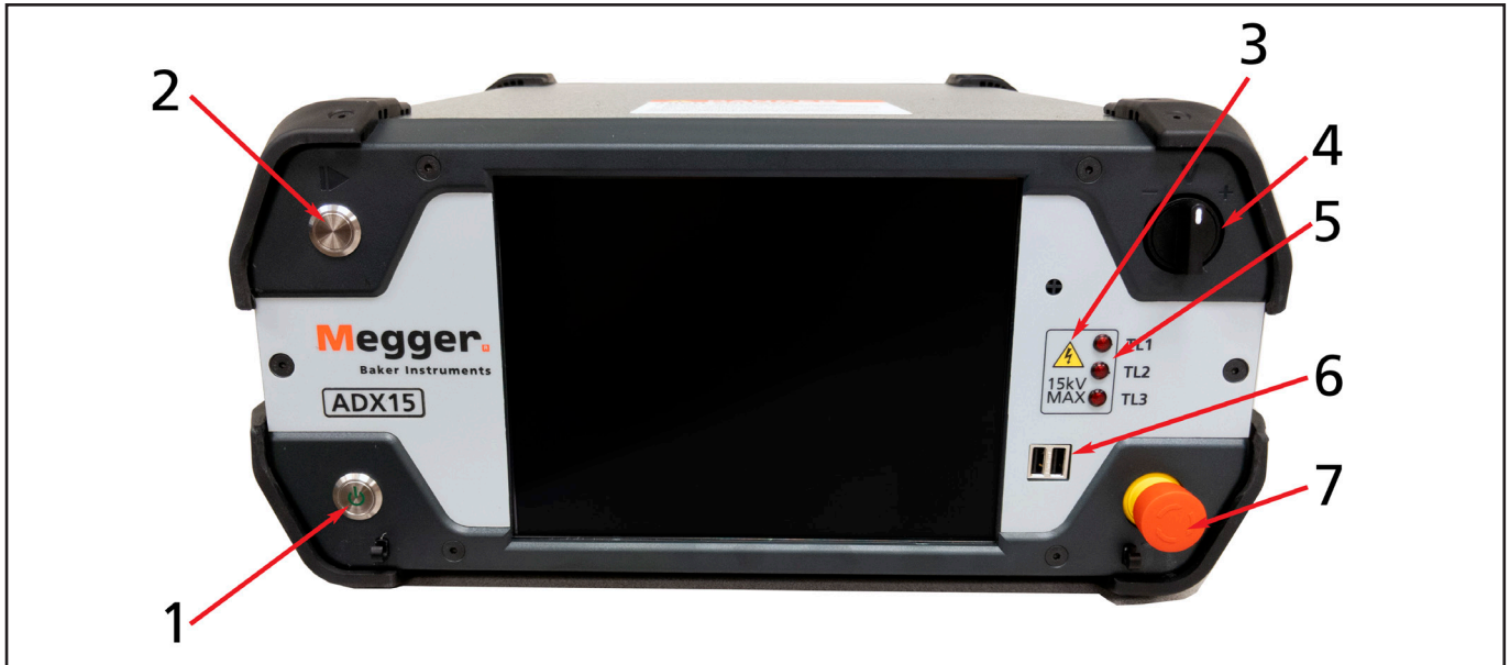
Fig. 5: Controles y funciones del panel frontal: ADX15.
