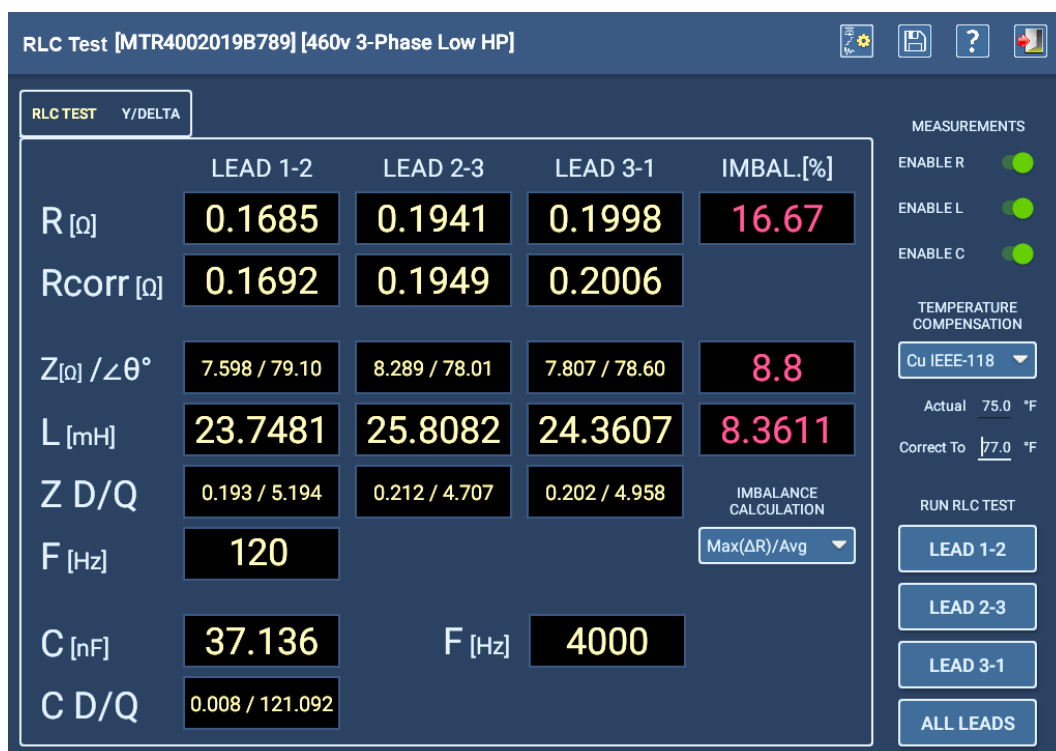
Fig. 81: Prueba manual: pestaña de resultados de la prueba principal de RLC.
