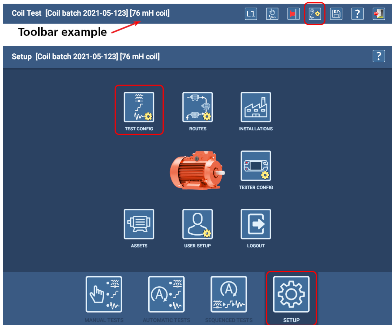
Fig. 41: Acceda a Test Configuration Editor (Editor de configuración de prueba) desde el menú principal de Setup (Configuraciones) o el ícono en la parte superior de muchas pantallas de prueba.
