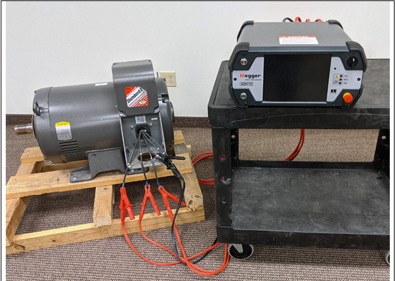
Fig. 28: Asegurarse de que los cables de prueba del ADX y los cables del activo estén correctamente separados y ubicados.
