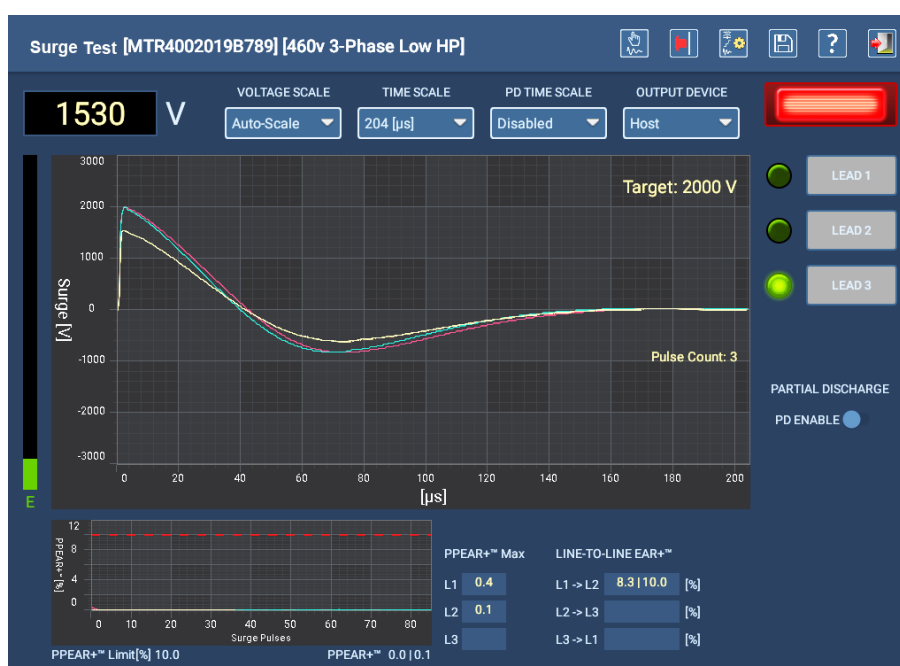
Fig. 87: Prueba de sobretensión manual en curso.
