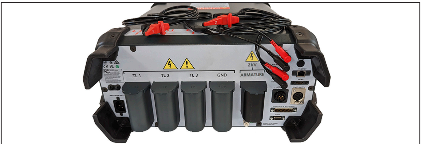
Fig. 102: Las pruebas de Armature RLZ utilizan conectores RLC y sondas o clips portátiles (se muestra el juego de clips).
