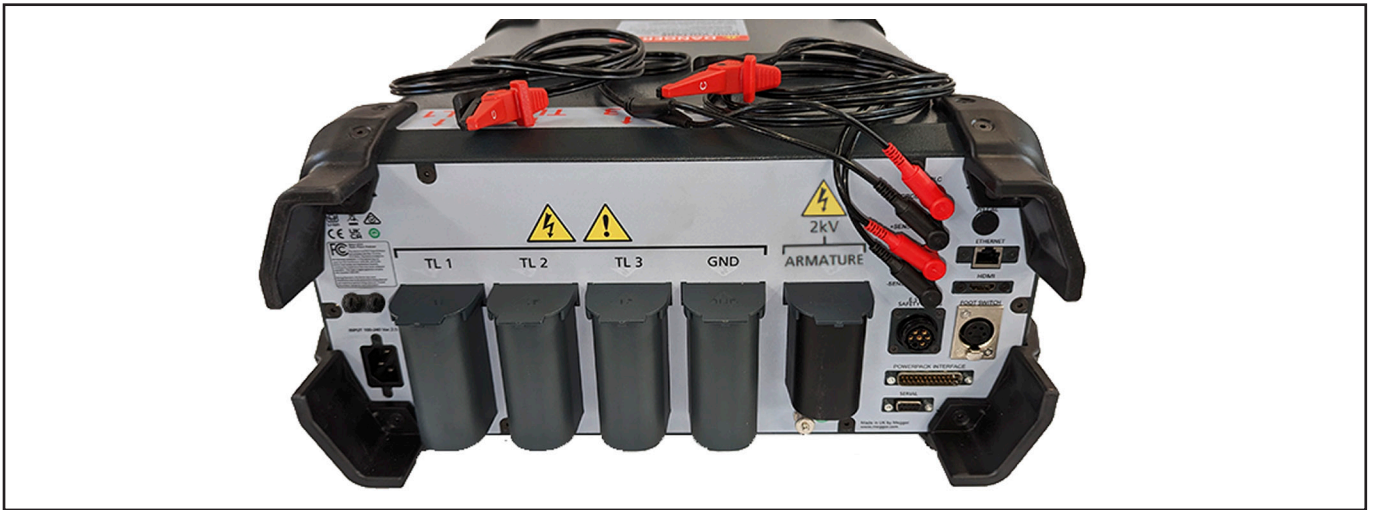
Fig. 131: Conectores RLC con juego de clips.
