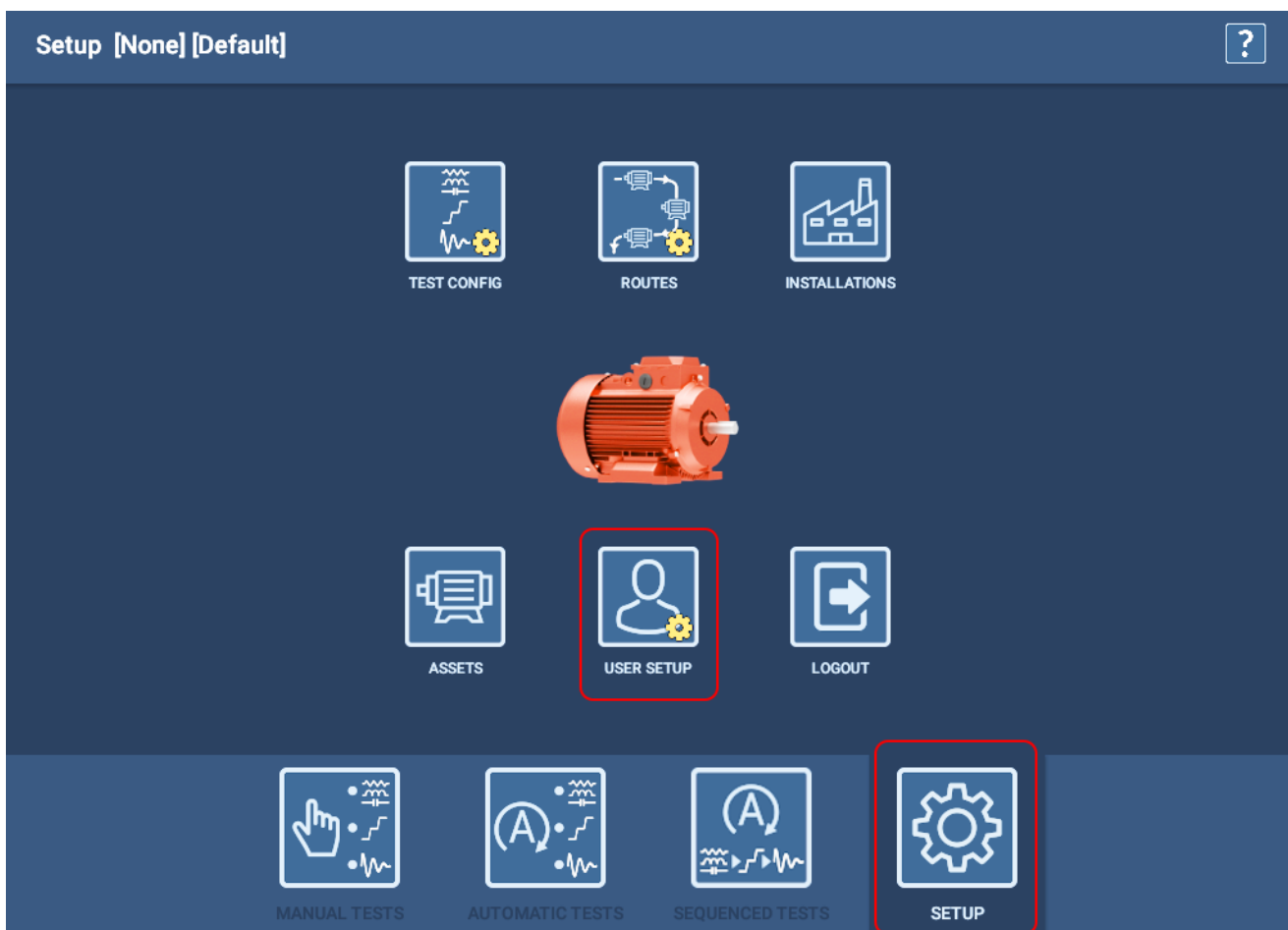
Fig. 29: El modo SETUP (Configuración) proporciona a los administradores acceso a la pantalla User Setup (Configuración del usuario).
