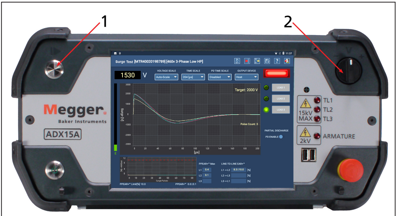
Fig. 88: Controles del panel frontal ADX para iniciar la prueba de sobretensión.
