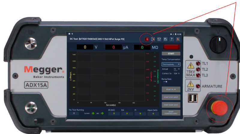
Fig. 2: Baker ADX de Megger mostrando el botón de parada del equipo.
