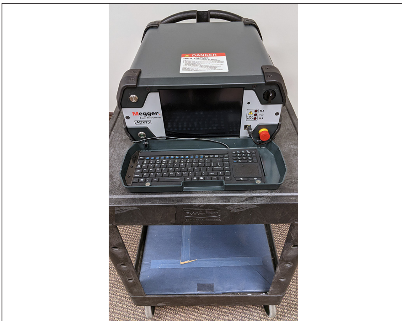
Fig. 20: Si el ADX se apoya en el carro de trabajo; todos los soportes inferiores están haciendo contacto completo; las ruedas están bloqueadas.
