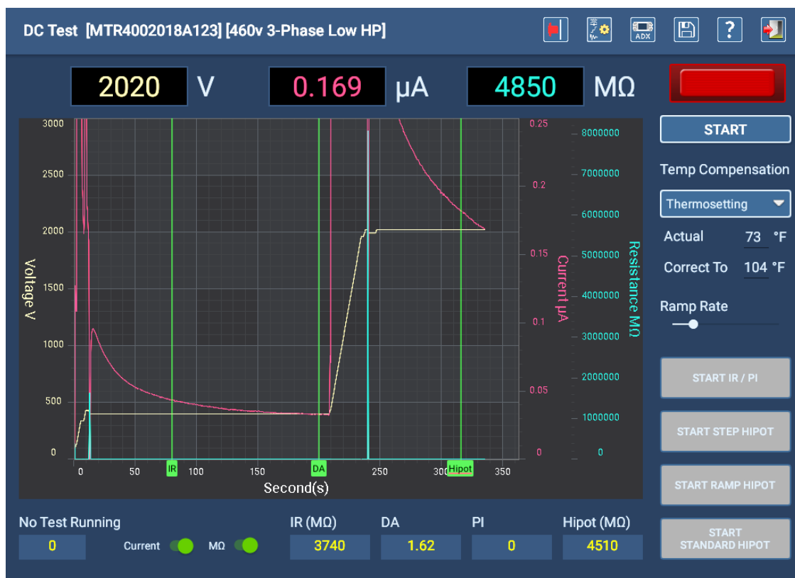
Fig. 84: Pantalla Manual DC Test (Prueba manual de CC): pruebas completadas.
