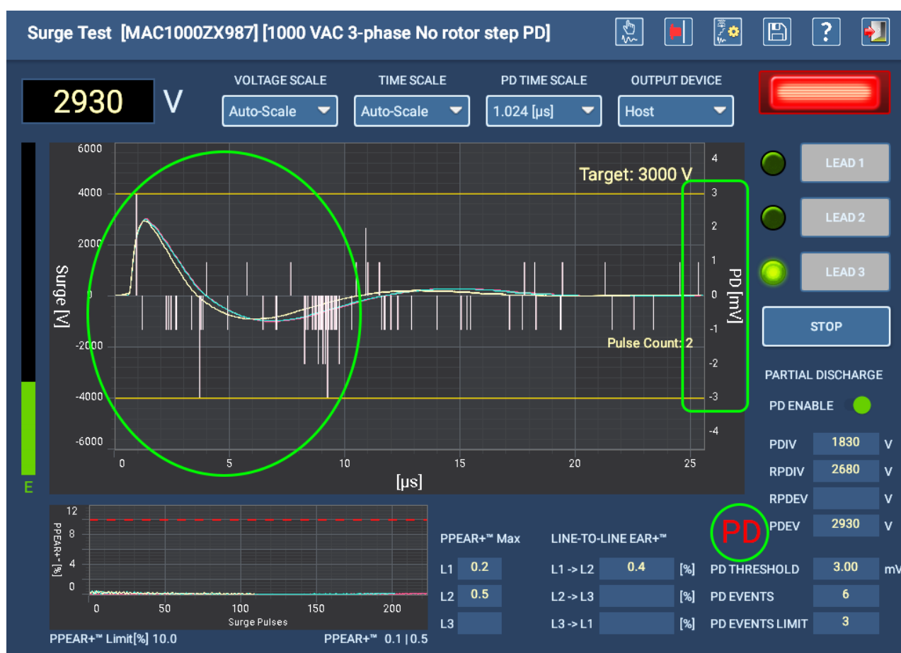
Fig. 113: Pantalla Surge Test (Prueba de sobretensión) de ADX con PD activado y valores registrados.
