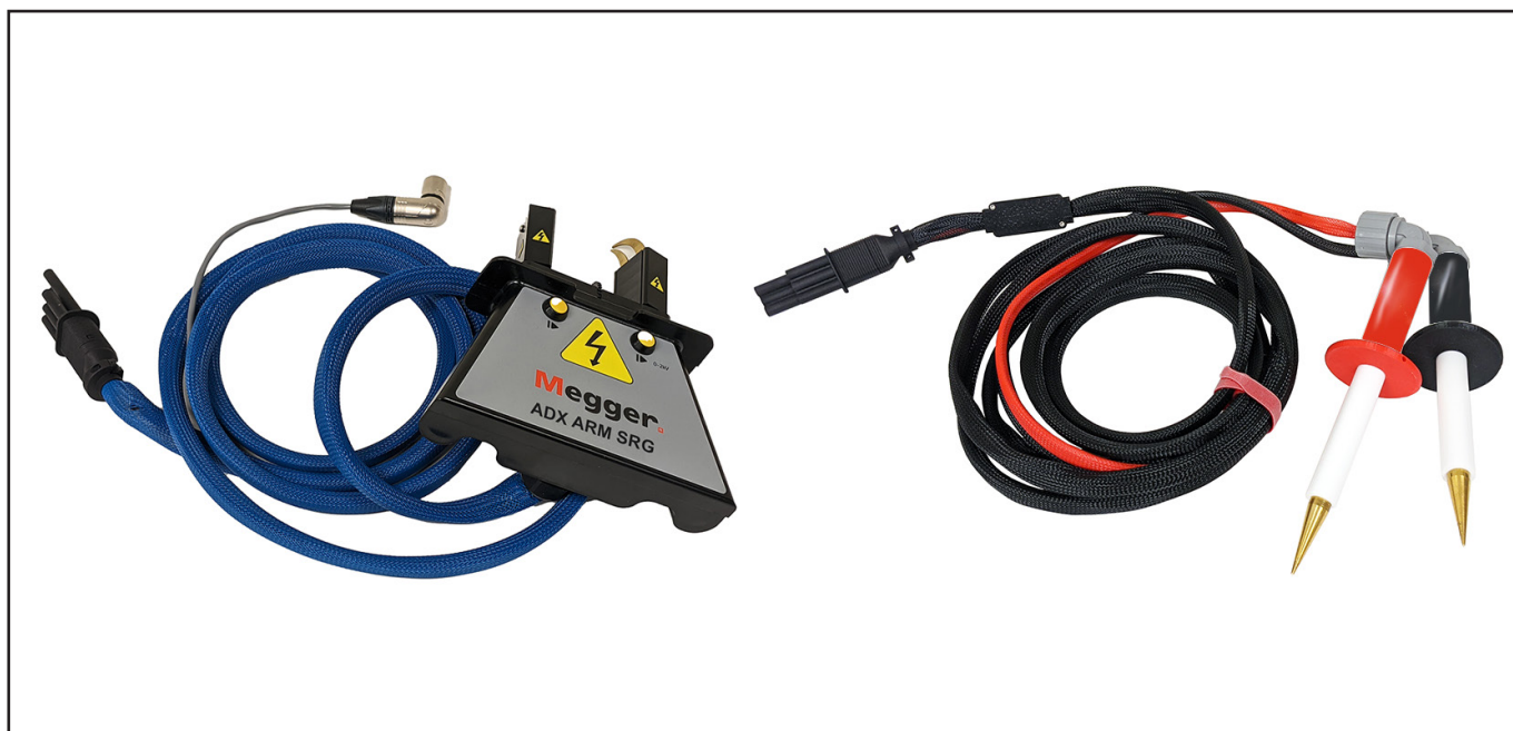
Fig. 104: Las pruebas de sobretensión del inducido utilizan un adaptador ADX ARM SRG o sondas manuales para pruebas de sobretensión.
