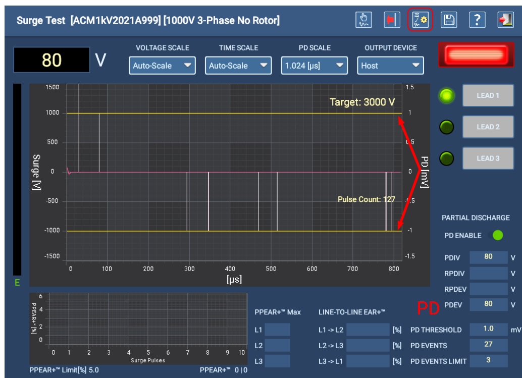
Fig. 117: Pantalla Surge Test (Prueba de sobretensión) en modo Manual para configurar los parámetros de PD.
