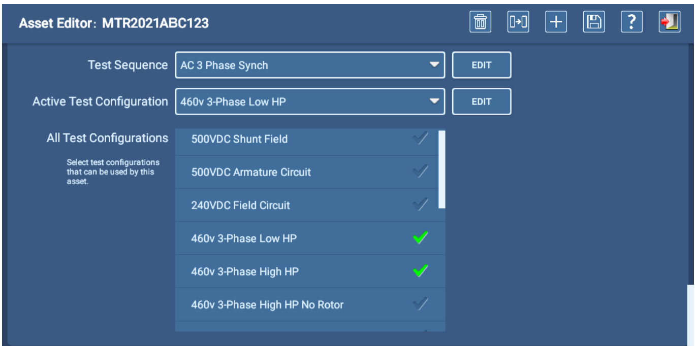
Fig. 54: Pantalla Asset Editor (Editor de activos); selección de configuraciones de prueba y secuencia de prueba.
