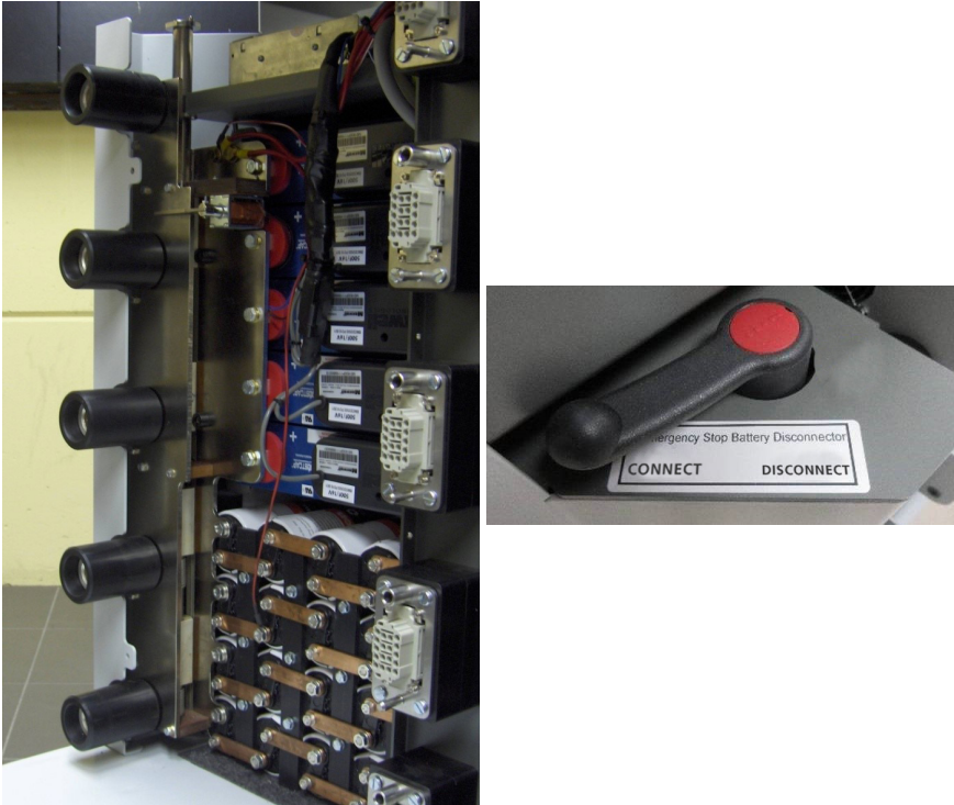
Fig. 4: Carro de soporte: Dispositivo de parada de emergencia.
