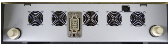
Fig. 79: Salidas de aire de generador de corriente de CC
