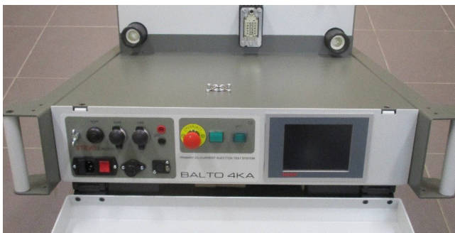
Fig. 11: Sistema BALTO Compact: Unidad principal.
