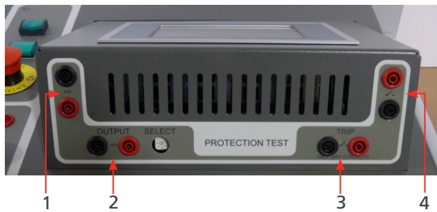
Fig. 8: Unidad de control: Relé de protección de CC de la interfaz.
