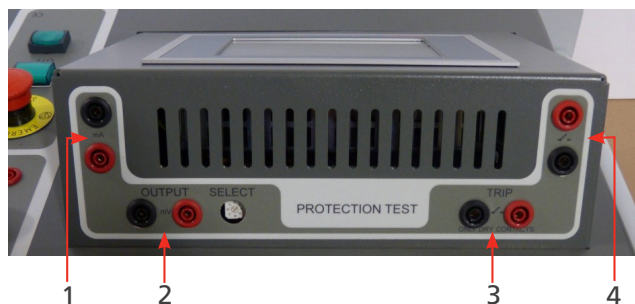
Fig. 33: Unidad de control: Relé de protección de CC de la interfaz.
