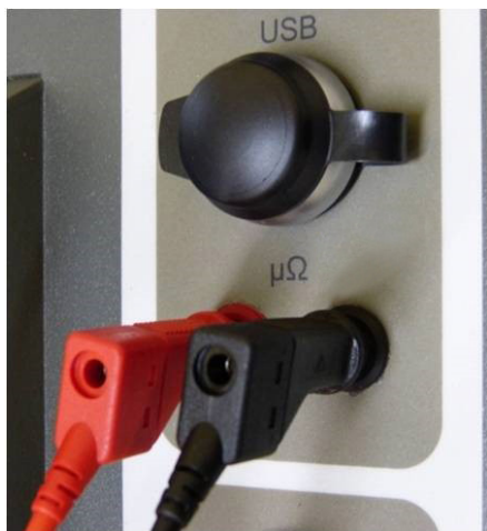
Fig. 62: Panel de control: conexión para medición de \mu\Omega hmios.
