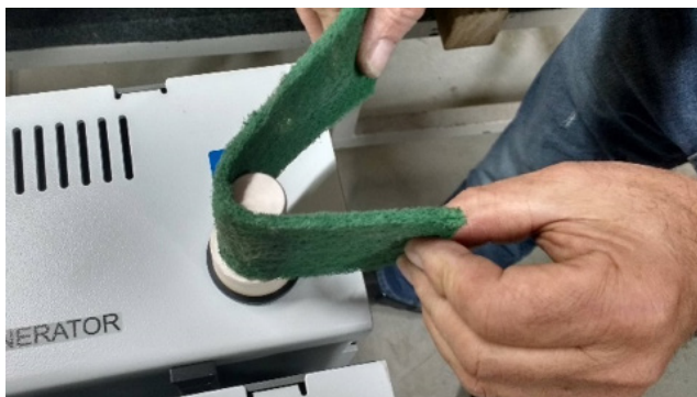
Fig. 76: Limpieza del conector de alimentación.
