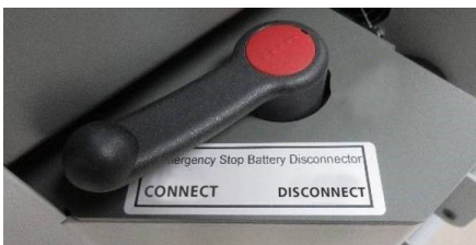
Fig. 14: Dispositivo de parada de emergencia.
