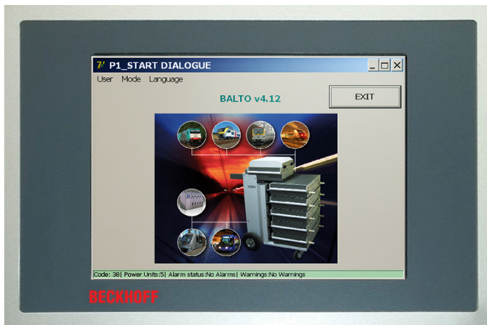
Fig. 44: Panel de control: Pantalla táctil - IHM
