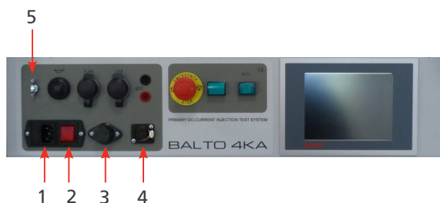
Fig. 15: Alimentación, fusibles y conector de carga
