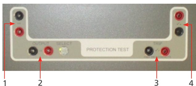
Fig. 16: Interfaz de relés de protección de CC
