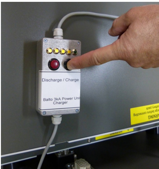
Fig. 52: Carga de un generador de corriente de CC.
