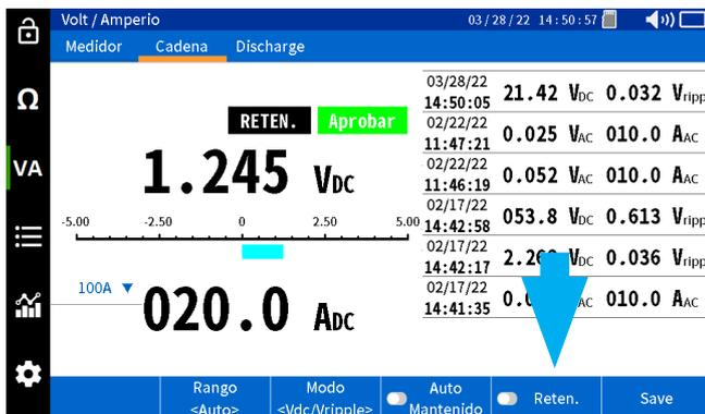
Pulse "Save" (Guardar) para guardar manualmente el valor con una marca de fecha y hora.
