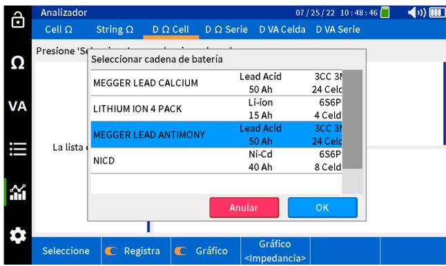
Seleccione la celda deseada en la columna de la izquierda.
