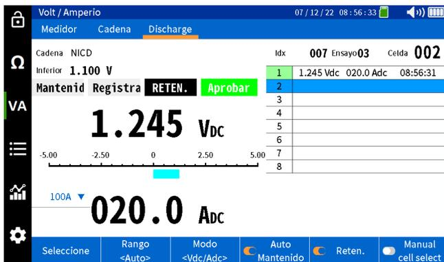
Efectúe la medición de todas las celdas subsiguientes. Todas las mediciones se guardarán en una secuencia con un número de celda y una marca de fecha y hora.
