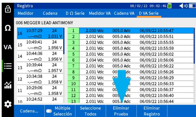
Para eliminar un registro, seleccione el registro deseado en la columna derecha y, a continuación, seleccione "Eliminar Registro".
