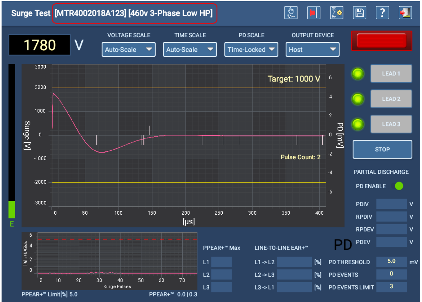
Fig. 77: Ejemplo de pantalla de medida en la que se muestran el activo seleccionado y la configuración de medida.
