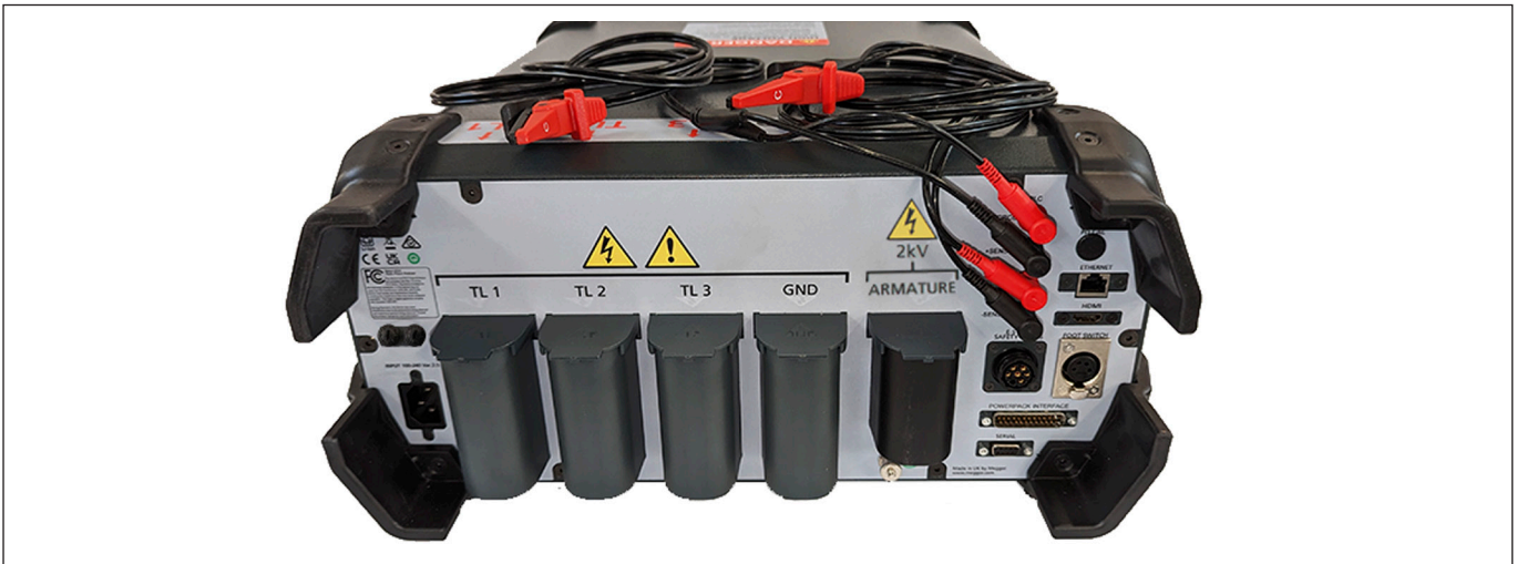
Fig. 102: Las pruebas de Armature RLZ utilizan conectores RLC y sondas o clips portátiles (se muestra el juego de clips).
