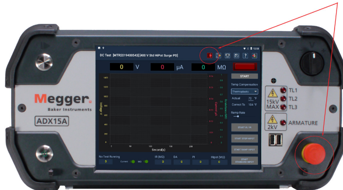
Fig. 2: Baker ADX de Megger en el que se muestra el botón de parada del equipo.
