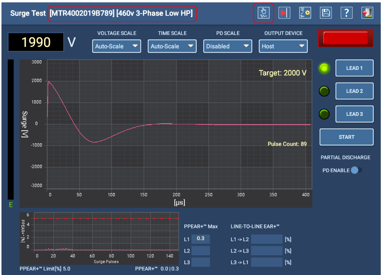
Fig. 89: Adquisición de la forma de onda de referencia para la medida de onda de choque en LEAD 1 (Cable 1).
