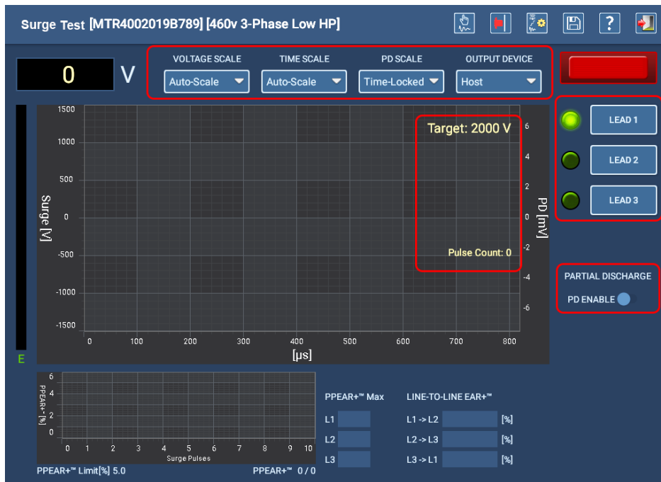
Fig. 86: Pantalla de inicio de medida de onda de choque manual; descarga parcial desactivada.
