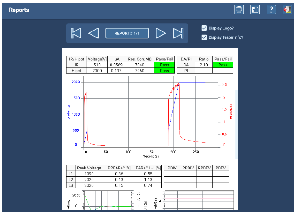
Fig. 138: Pantalla de informes con informe de ejemplo—Sección de medida de CC.
