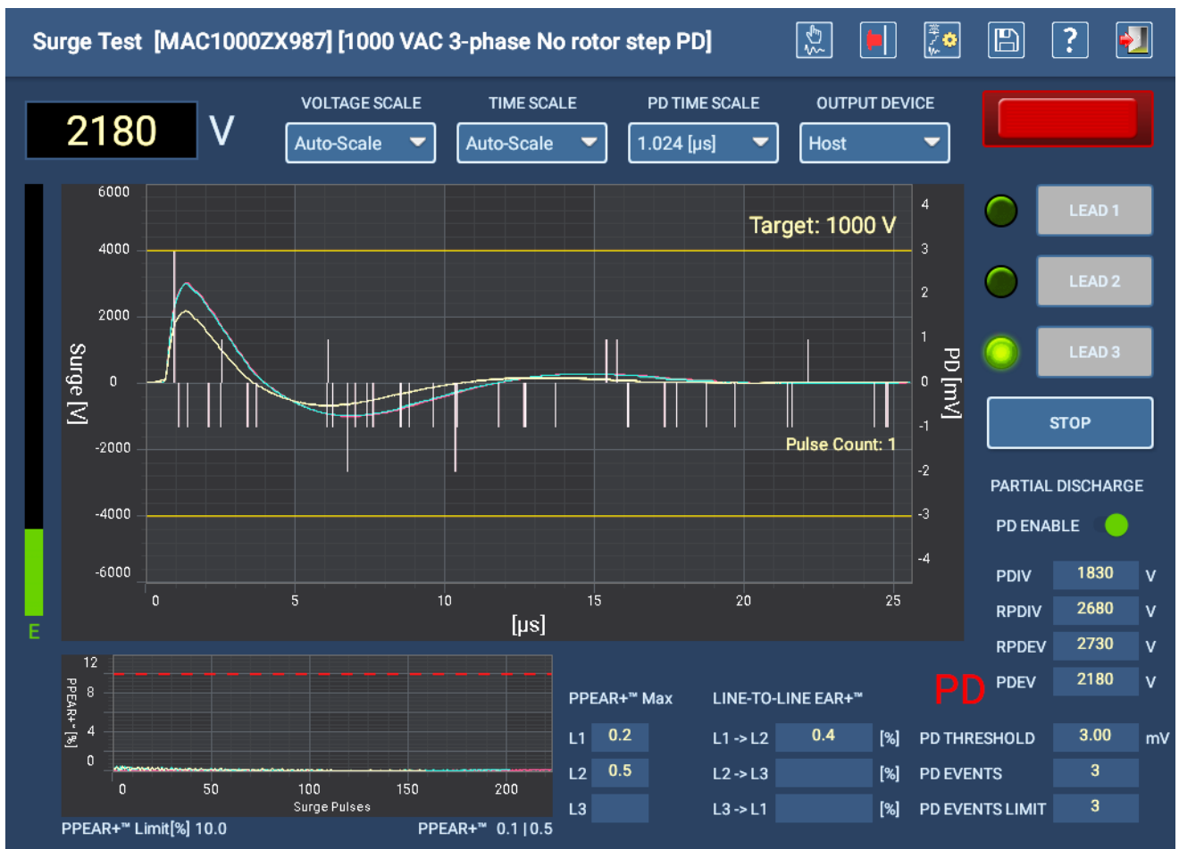
Fig. 114: Caída de tensión para aplicar una rampa descendente hasta el valor objetivo (aquí, 1000 V), con captura de los valores de extinción correspondientes al cable 3.
