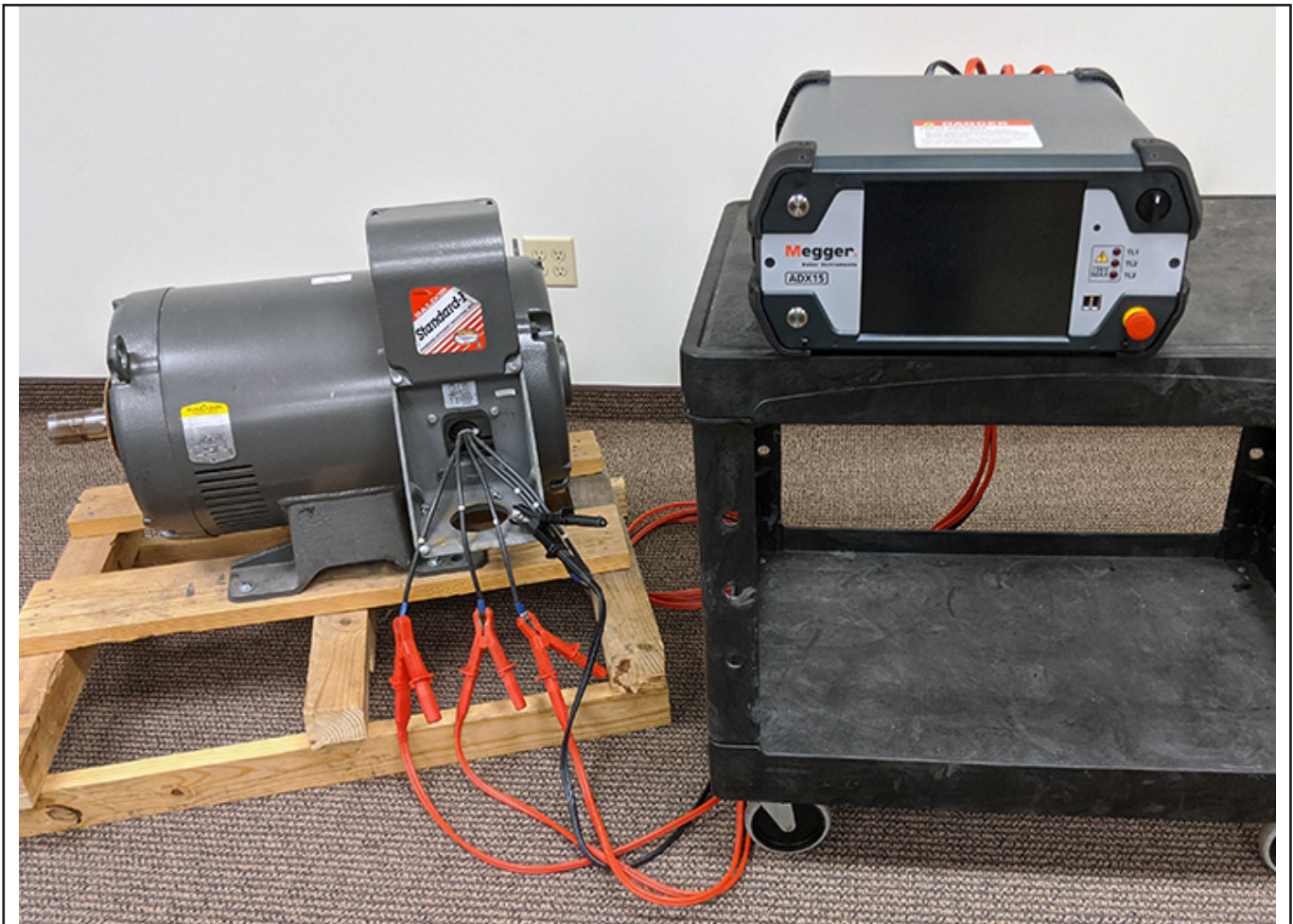
Fig. 28: Asegúrese de que los cables de medida del ADX y los cables del activo están correctamente separados y ubicados.
