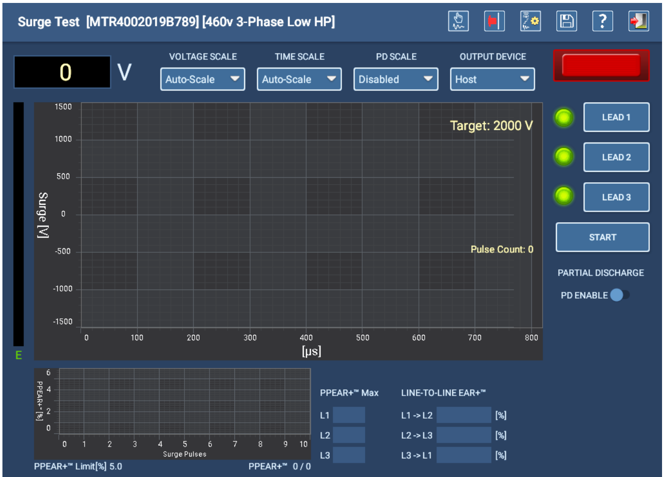
Fig. 110: Pantalla de medida de onda de choque automática—Inicio.
