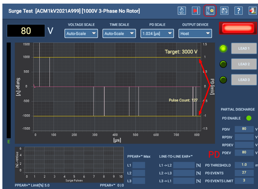
Fig. 117: Pantalla Surge Test (Medida de onda de choque) en modo manual para el establecimiento de parámetros de DP.
