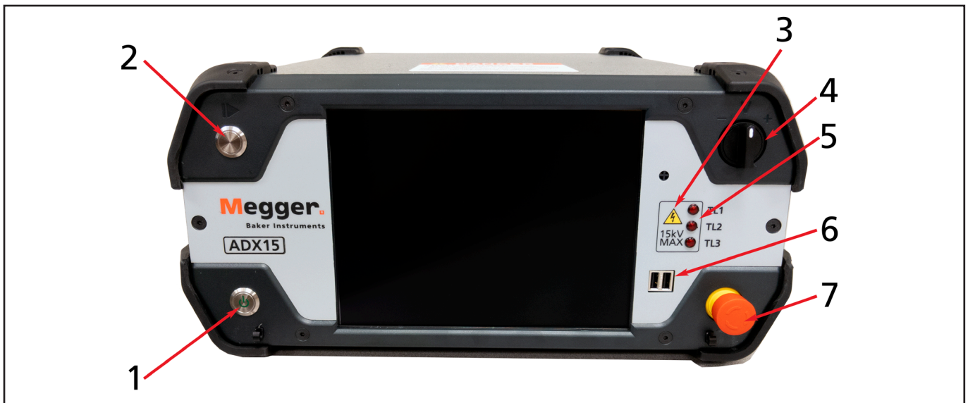
Fig. 5: Controles y funciones del panel frontal: ADX15.
