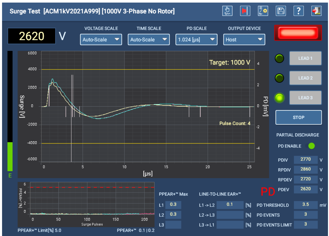
Fig. 118: Medición de onda de choque con DP en modo automático para confirmar la configuración.
