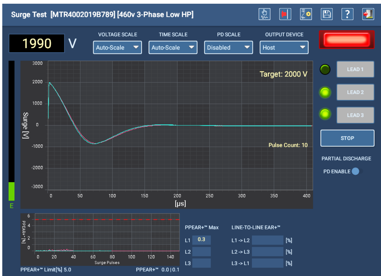
Fig. 125: Pantalla de medida de onda de choque automática.
