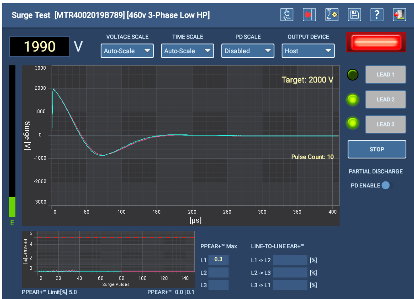
Fig. 111: Pantalla de medida de onda de choque automática — Medida en curso.
