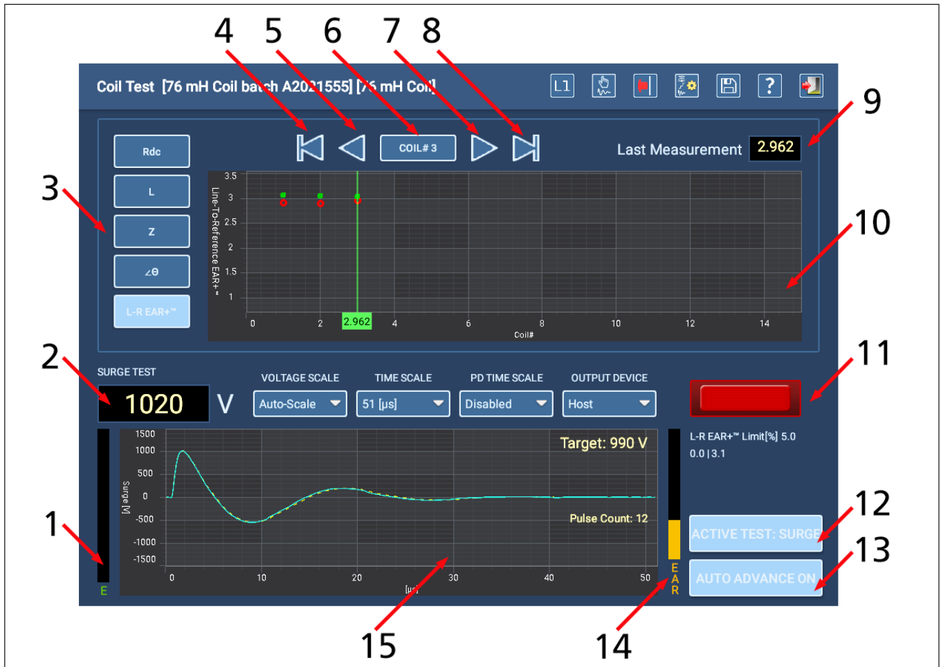
Fig. 98: Elementos de la pantalla Coil Test (Medida de bobina).
