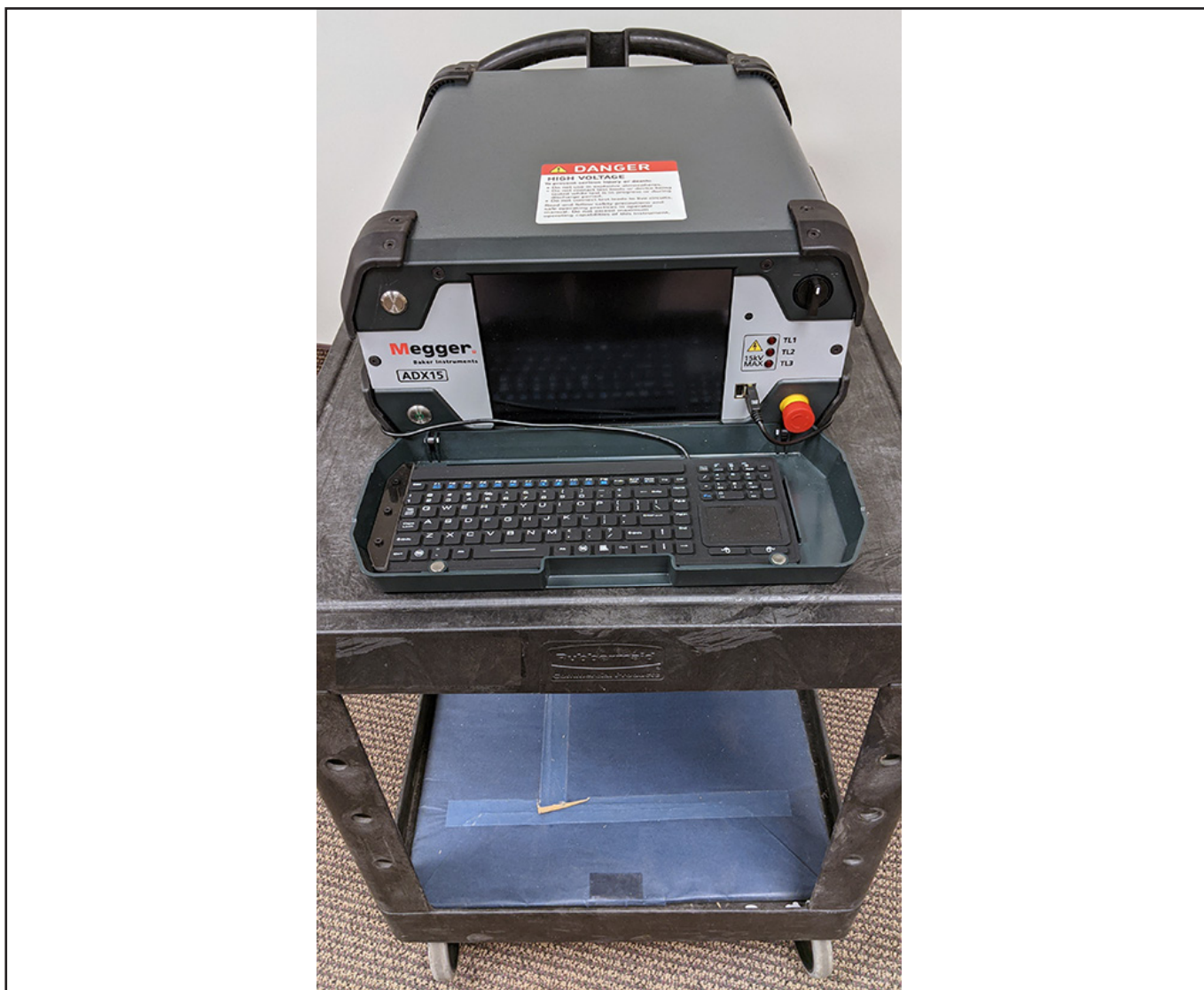
Fig. 20: ADX sobre el carro de trabajo; todos los topes inferiores hacen contacto total; ruedas bloqueadas.
