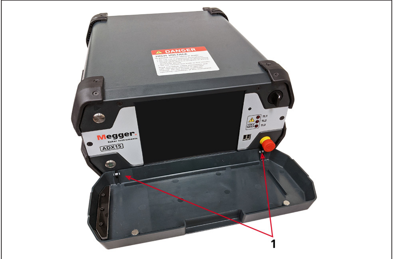
Fig. 21: Coloque los pasadores de bisagra antes de extraer la bandeja del teclado.
