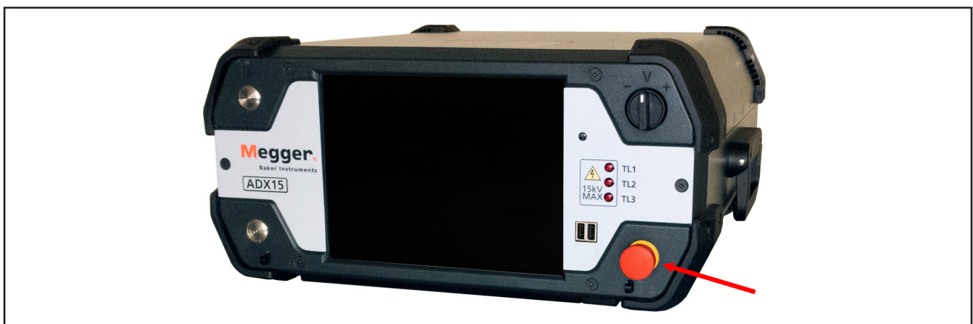
Fig. 145: Megger Baker ADX en el que se muestra el botón de parada del equipo.
