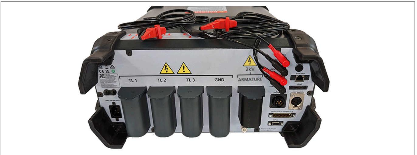
Fig. 131: Conectores RLC con juego de clips.
