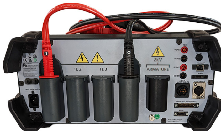
Fig. 3: Inspeccione los receptáculos y los hilos de los cables de prueba antes de cada uso.
