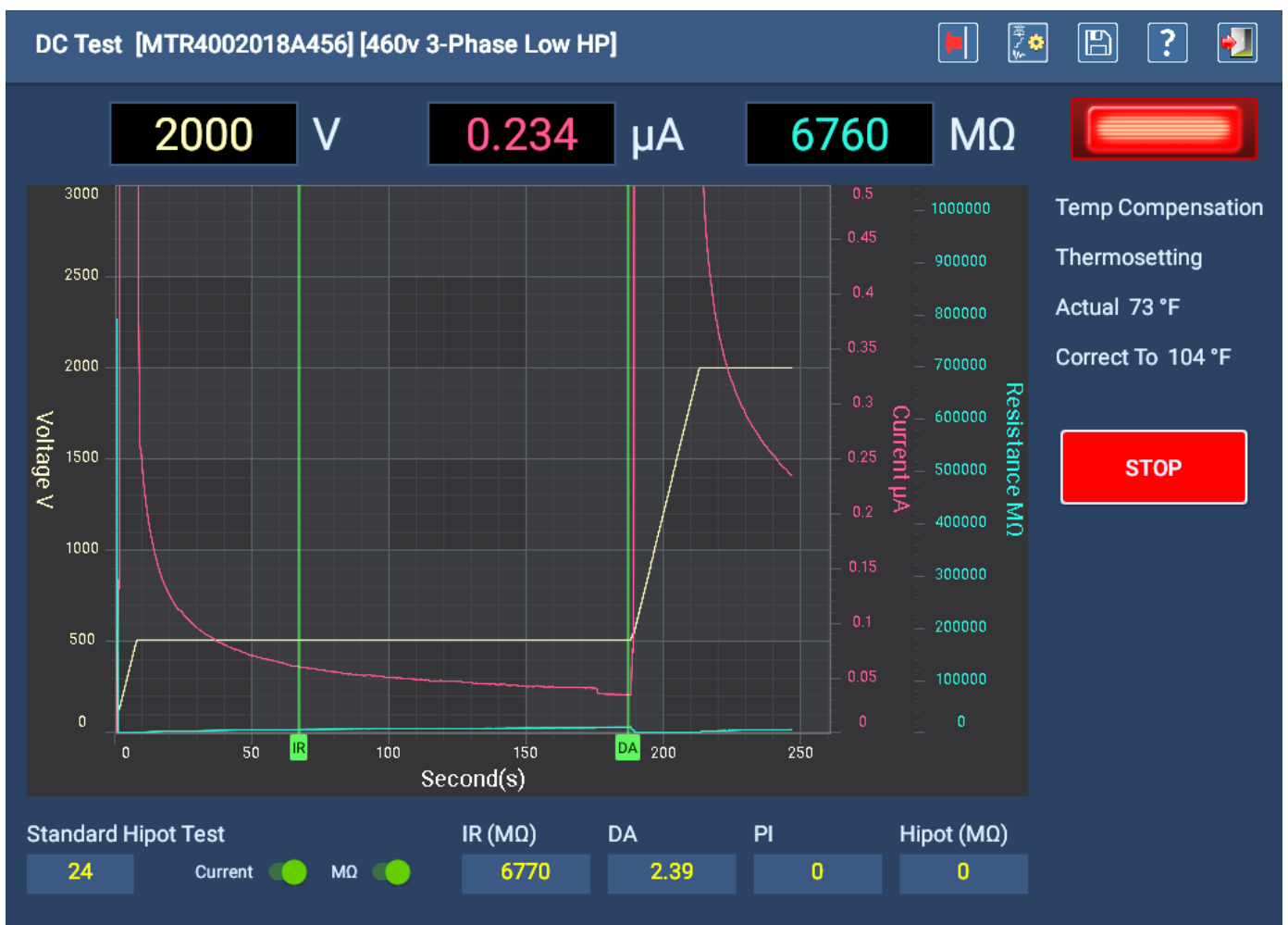
Fig. 108: Pantalla Auto DC Test (Medida de RLC automática) durante la ejecución de una medida de Hipot estándar.
