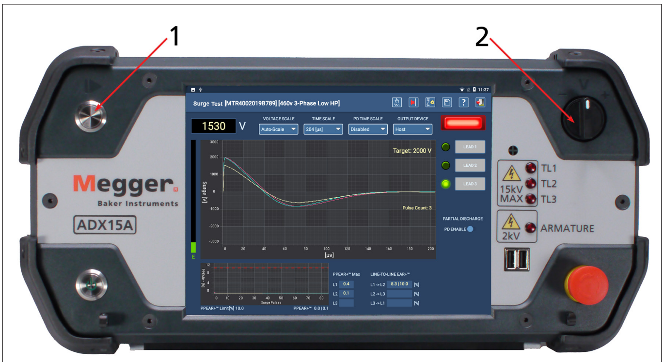
Fig. 88: Controles de panel delantero del ADX para iniciar la medida de onda de choque.
