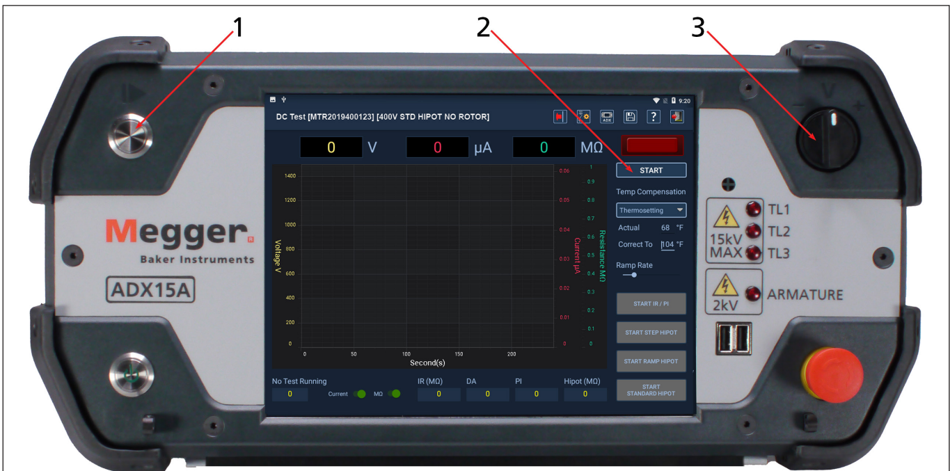
Fig. 85: Panel delantero del ADX y controles de interfaz de usuario para iniciar la medida de CC.
