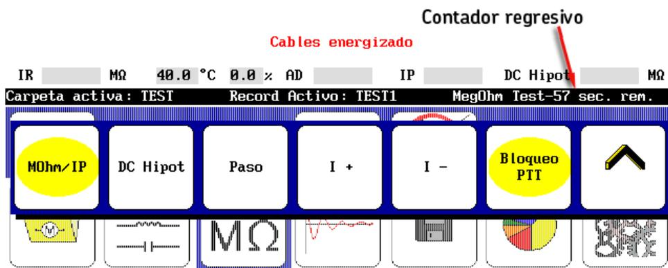
Figura 20. Barra de estado con temporizador de cuenta regresiva.
