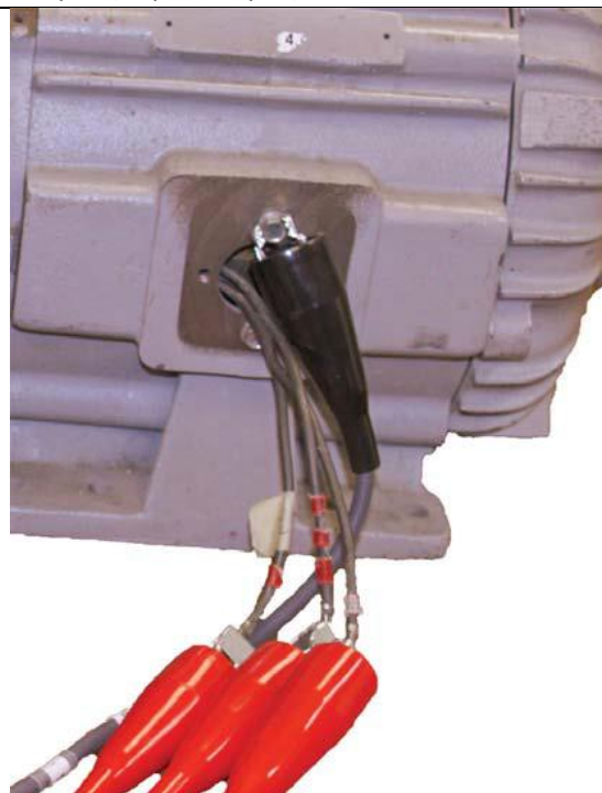
Rysunek 36. Przymocuj przewody silnika do przewodów pomiarowych.
