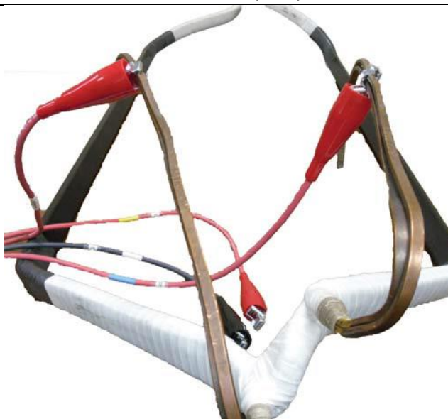
Rysunek 41. Podłączyć przewody pomiarowe do wyprowadzeń cewki.
