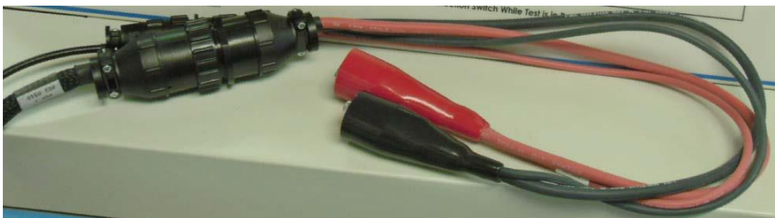
Rysunek 119. Podłącz przewód główny do przewodów z klipem
