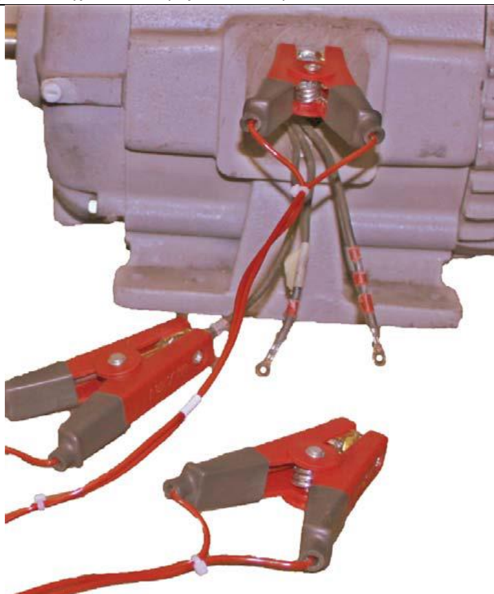
Rysunek 20. Podłącz przewody RLC w nowej konfiguracji.
