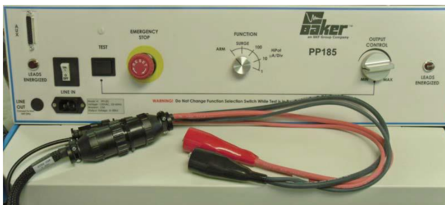
Rysunek 104. Podłącz przewody z klipem do Przewód testowych.
