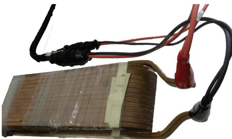
Rysunek 105. Podłączanie przewodów z klipem do cewki wzbudzenia.
