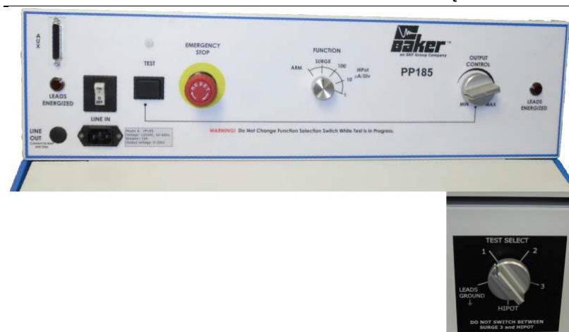
Rysunek 72. PP85 - 30 Power Pack z trójfazowym przełącznikiem (prawy dolny panel przedni).
