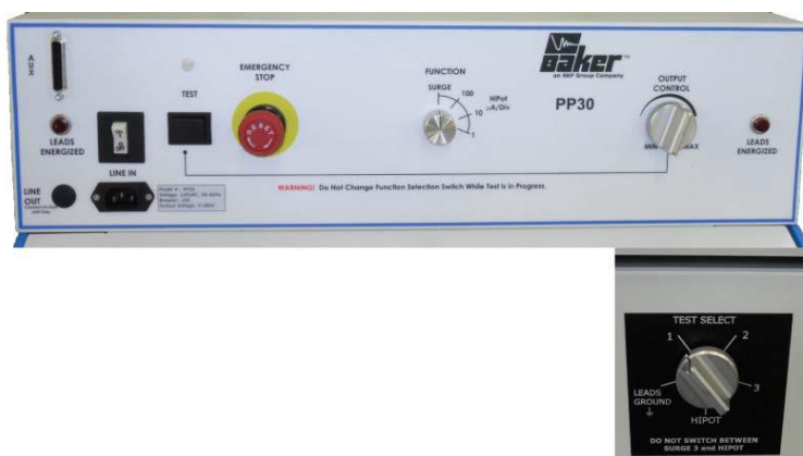
Rysunek 71. PP30 - 30 Power Pack z trójfazowym przełącznikiem (prawy dolny panel przedni).
