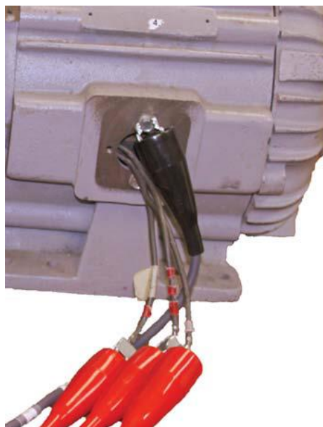
Rysunek 26. Przymocuj przewody silnika do przewodów pomiarowych.
