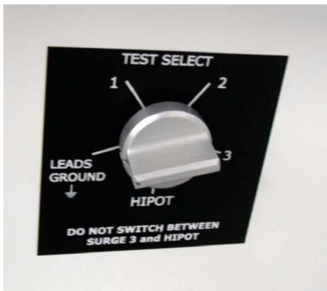
Rysunek 93. Trójfazowy przełącznik – pozycja masy
