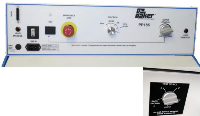
Rysunek 94. PP85 – Zasilacz 30kV z trójfazowym przełącznikiem (prawy dolny panel przedni).
