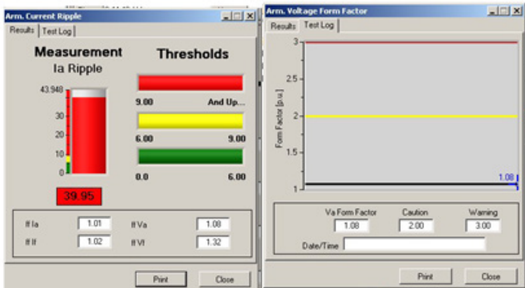
Fig 114: Factor de forma de tensión de armadura.
