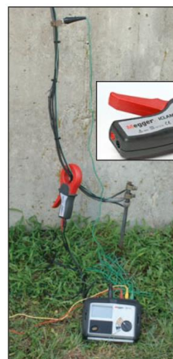
Cęgi pomiarowe prądowe ICLAMP używane w metodzie ART (metodzie technicznej trzyprzewodowej z cęgami)
