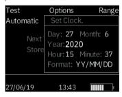
El valor DD/MM/AA inferior muestra el formato de fecha actual. Al pulsar la flecha hacia arriba del control del cursor, alternará entre las opciones disponibles: DD/MM/AA, MM/DD/AA o AA/MM/DD.
