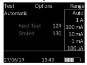
El DLRO10X utiliza una corriente de medida de entre 100 µA y 10 A para medir la resistencia del elemento que se está midiendo. Si se establece en AUTO (AUTOMÁTICO), el DLRO10X seleccionará la corriente en función la resistencia que detecte. (Consulte Especificaciones, Rangos)
