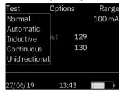
En este submenú se selecciona el modo de medida. Solo puede activarse un modo cada vez; el modo activo se muestra bajo el encabezado TEST (MEDIDA). (Consulte los Modos de medida, indicados más adelante en este manual, para obtener más información sobre cada modo).
