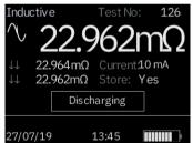
Aparecerá un mensaje que indique CURRENT FLOW (FLUJO DE CORRIENTE) si una corriente mayor de 1 mA continúa fluyendo una vez terminada la medición. Esto implica que la carga inductiva se ha medido y todavía se está descargando. No desconecte el bucle activo mientras se muestra la advertencia de descarga.
