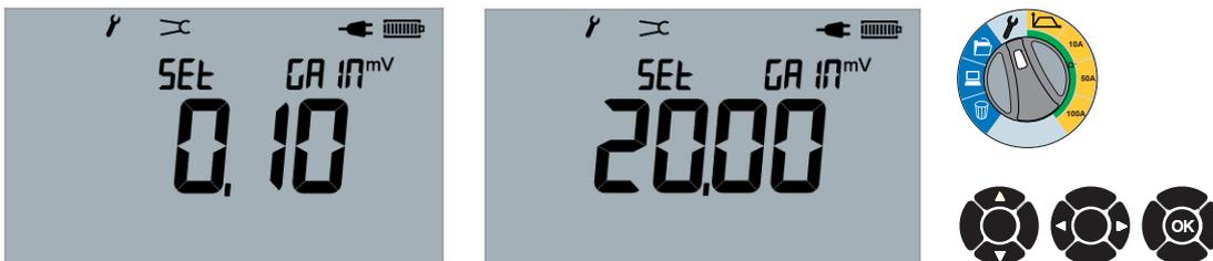
Ajuste la ganancia con las flechas ARRIBA y ABAJO entre 0,1 mV/A y 20,00 mV/A.
