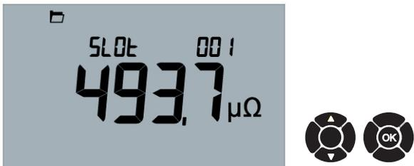
Desplácese hacia arriba y abajo por los resultados mediante el número de ranura. Pulse OK (Aceptar) para mostrar los resultados
