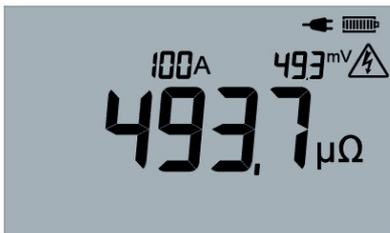
La pantalla muestra la corriente que fluye por el objeto de prueba, la tensión medida y la resistencia calculada. Si no se alcanza la corriente necesaria, el valor de corriente parpadeará.
