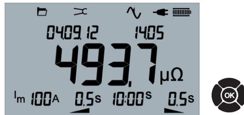
Pulse OK (Aceptar) para profundizar en el resultado. A continuación, pulse OK (Aceptar) para volver a la pantalla anterior en la que se muestran los números de ranura.
