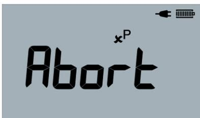
Prueba cancelada: existe una serie de condiciones que pueden causar una cancelación. En este ejemplo se muestra una conexión deficiente.
