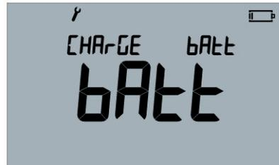
Vuelva a conectar la alimentación de CA. El menú pasará automáticamente al siguiente elemento con el símbolo de la batería animado para indicar el ciclo de carga.
