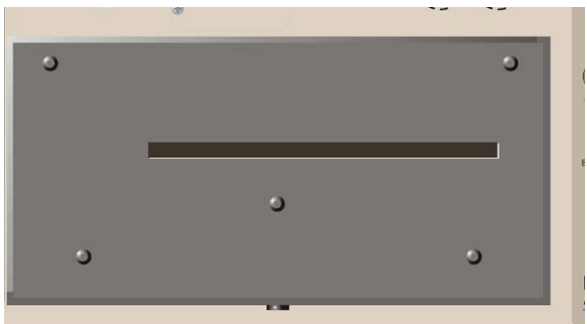
Den nya versionen av skrivare har fem skruvar på täckplåten
