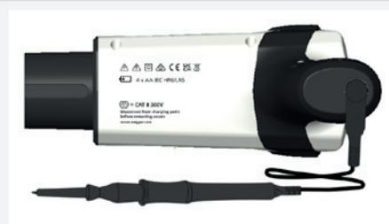
3. Conecte el EVCC300 a la salida del cargador, ya sea directamente en un conector tipo 2 o con el adaptador suministrado en un conector tipo 1.
