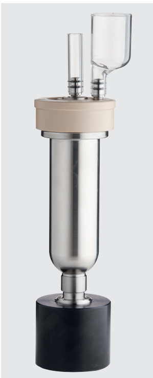
Celda de prueba totalmente ensamblada en la base del conjunto, con embudos de llenado de vidrio.
