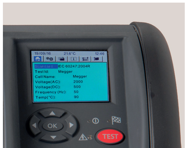
Interfaz de usuario de diseño tubular para una navegación y un control eficientes. Escritura de texto sencilla y desplegado conciso de la información de configuración y de las pruebas.
