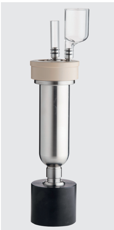
Helmonterad testcell i konstruktionsramen, med påfyllnads- och nivåkanaler i glas.
