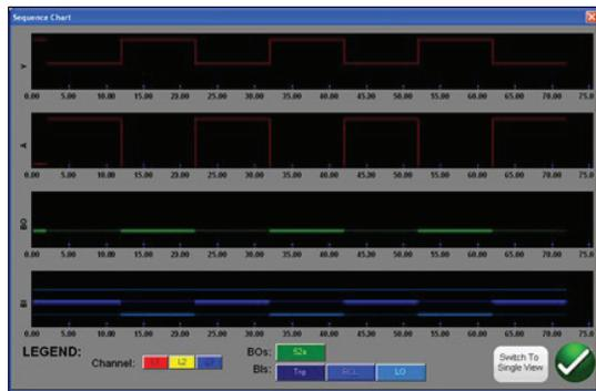
Figura 12: secuencia de ejemplo: tensión, corriente, entradas y salidas binarias
