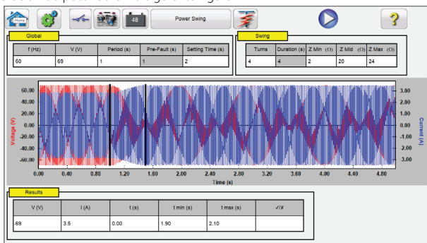
Figura 29 Pantalla Power Swing Input Setting (Ajustes de entrada de oscilación de potencia) y formas de onda
