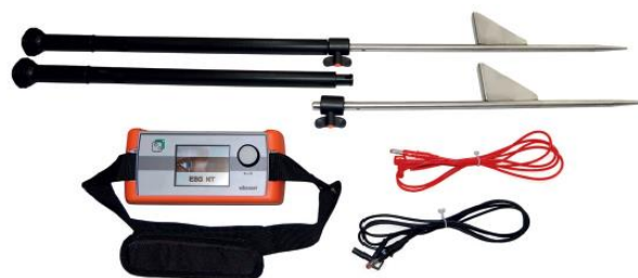
ESG NT – cyfrowy lokalizator zwarć doziemnych do lokalizacji dokładnej uszkodzeń powłoki izolacyjnej kabla (doziemień płaszcza) metodą spadku napięcia na powierzchni ziemi (napięcia krokowego)
