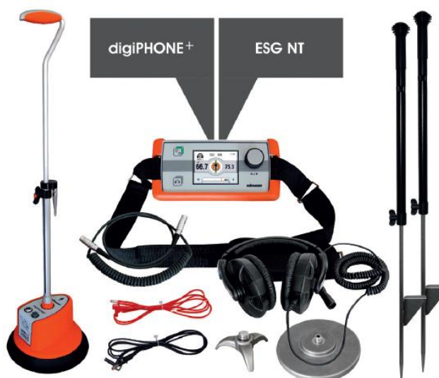
Zestaw digiPHONE+ NT – lokalizacja dokładna metodą akustyczno–sejsmiczną i lokalizacja dokładna uszkodzeń powłoki izolacyjnej kabla (doziemień płaszcza)
