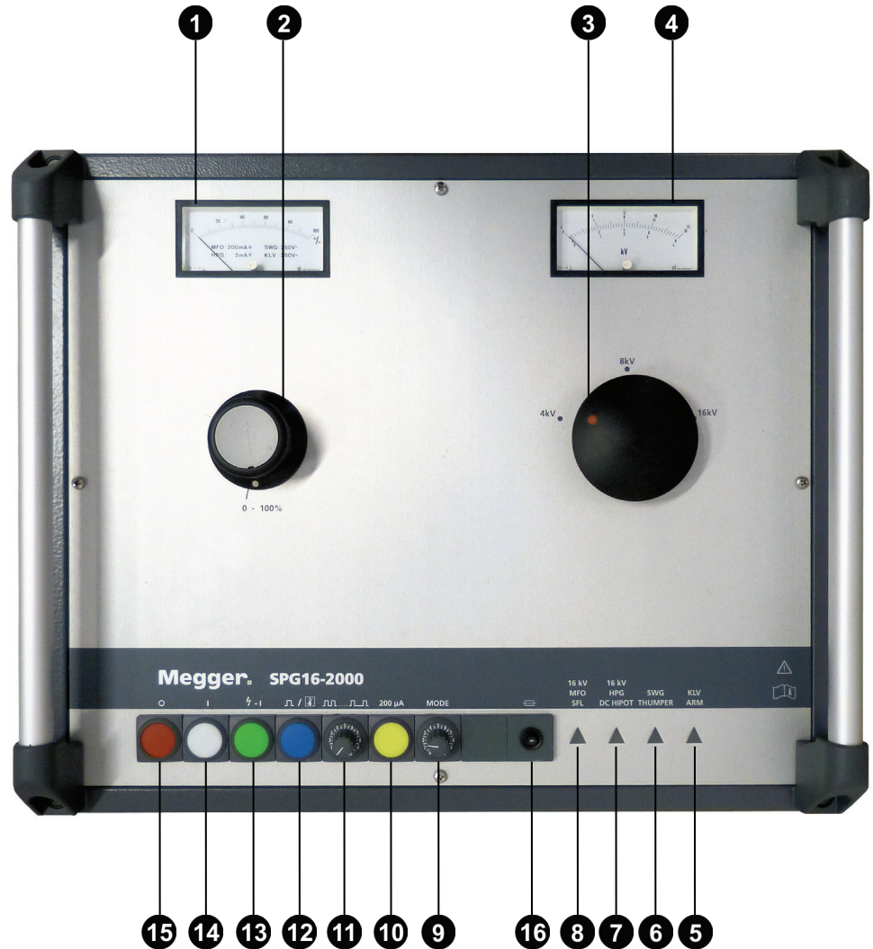
Imagen 5 : Panel de control e indicación del SPG 16
