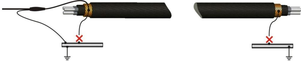
El aislamiento de cualquier cable de alimentación apantallado de tensión media o alta está protegido contra la entrada de agua mediante una camisa hecha de XLPE o PVC. La prueba de cubierta comprueba si la integridad de la camisa se ha visto comprometida, por lo general, durante la instalación.
