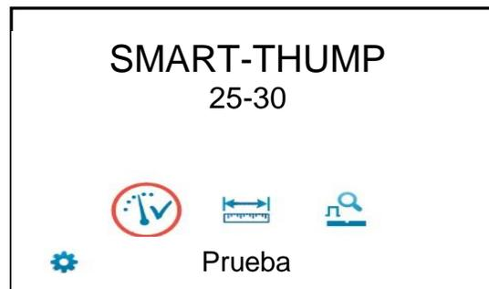
En este estado, la fuente de alta tensión todavía está apagada y la salida de alta tensión está conectada a tierra a través de una resistencia de descarga.
