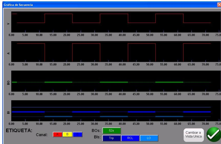
Figura 102 Vista Simple de la Pantalla de Vista Previa del Gráfico de Secuencia de Estado
