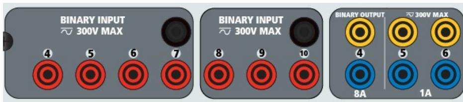
Figura 306 4 entradas binarias de 10 y Salidas binarias 4 a 6
