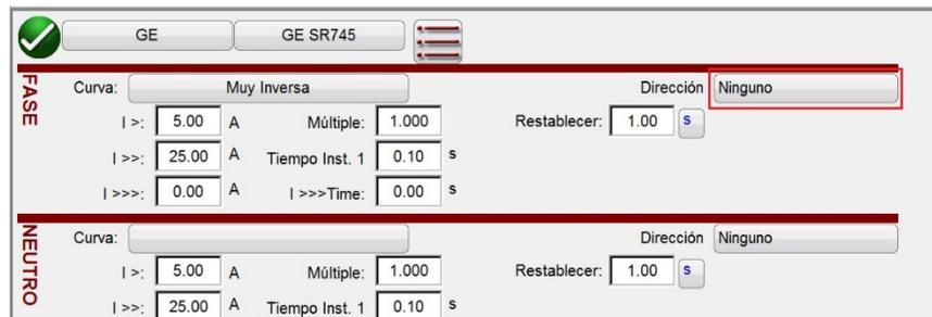
Figura 65 Ubicación del botón de dirección (recuadro naranja) en la ventana de configuración del relé
