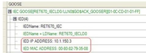
Figura 201 Dirección de IP del IED en el archivo SCL
