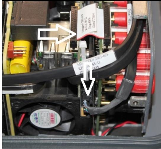
Figura 302 VIGEN1 a Cable del panel frontal
