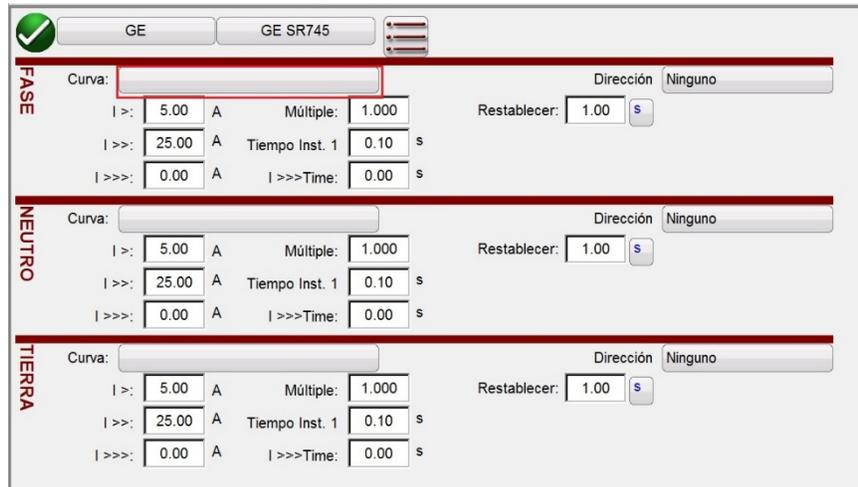
Figura 63 Ubicación del Botón de la Curva (recuadro naranja) en la ventana de configuración del relé
