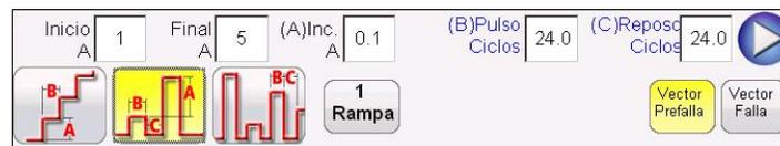
Figura 50 Ejemplo de Configuración de la Rampa de Pulso
