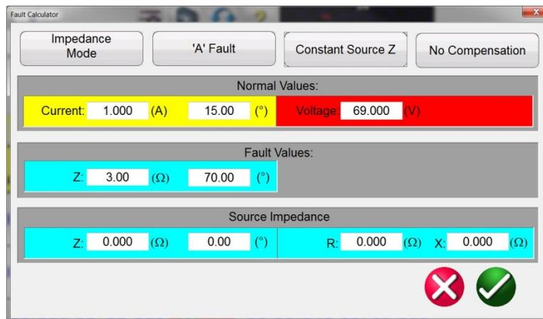
Figura 25 Modo de Impedancia, Impedancia Fuente Constante
