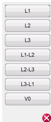
Figura 73 Este cuadro de dialogo permite al usuario ejecutar pruebas de falla de Fase a Fase individualmente, pruebas de falla Trifásica, o ejecutar todas las pruebas en un solo proceso.
