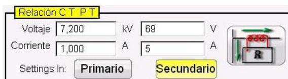
Los botones Primario y Secundario controlan la escala en el gráfico de impedancia y están asociados con los valores TC y TP introducidos. Introduzca los valores primario y secundario apropiados. Presione el botón primario y secundario y la escala óhmica cambiará en el gráfico de impedancia. La polaridad del TC también se puede definir en esta ventana.
