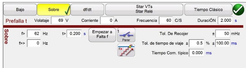
Figura 137 Configuración de prueba de relé de sobre frecuencia
