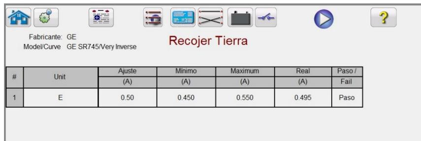
Figura 87 Esta tabla muestra los resultados de la Prueba de Captación de Tierra
