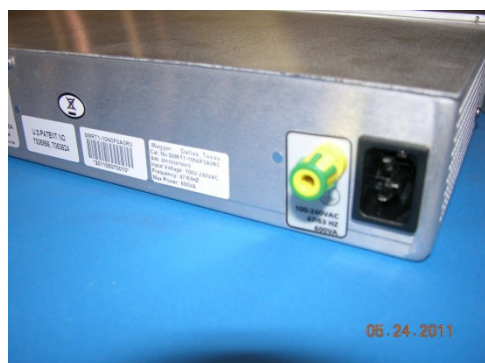
Figura 294. Entrada de alimentación en el panel trasero de una unidad SMRT1 montada en rack
