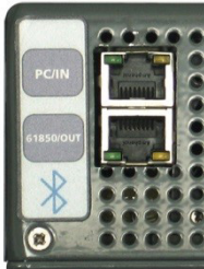
Figura 297. Puertos de comunicación de SMRT1
