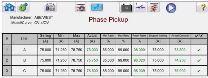
Figura 140. Ejemplo de pantalla de medida de corriente mínima y desconexión de fase
