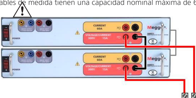
Figura 303. Canales de tensión en serie
