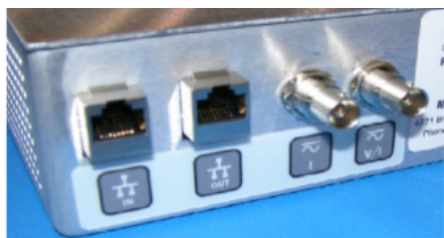
Figura 295. Puertos de comunicación y señal en el panel trasero de una SMRT1 montada en rack
