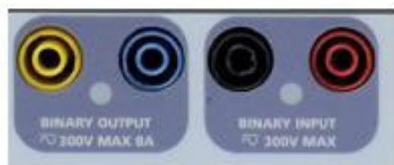
Figura 296. Entrada y salida binaria de SMRT1
