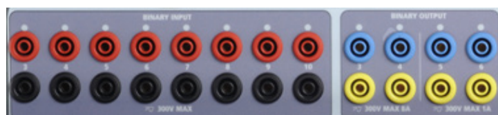
Figura 327. Entradas binarias de la 3 a la 10 y salidas binarias de la 3 a la 6 de la opción "P"
